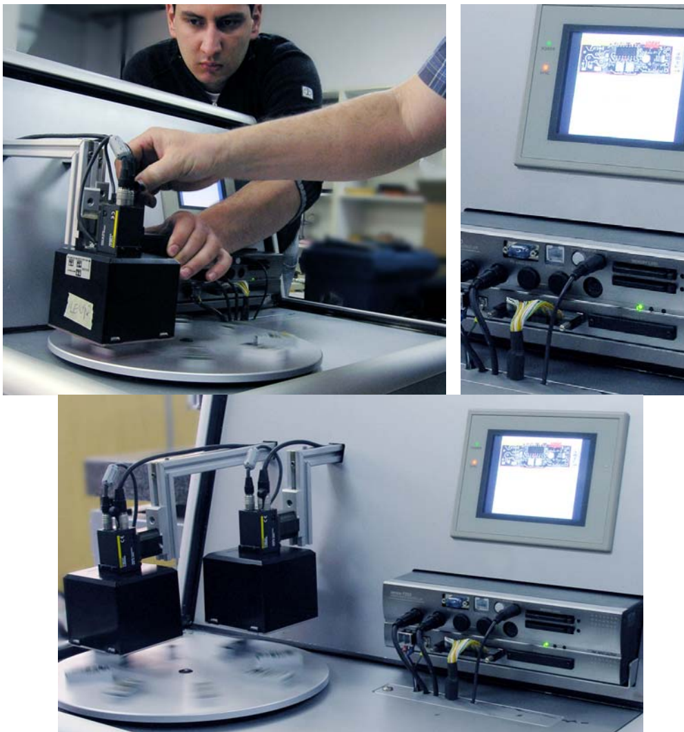
Slika 8: Fotografije Laboratorijske instalacije 3 – podešavanje i probni rad sistema industrijskih kamera i akvizicionog sistema za visokorezolutnu ultrabrznu obradu slike.
