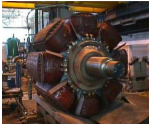
Fig. 3 Generador sincrónico con rotor de polos salientes
