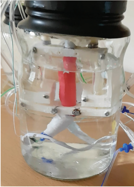
Şekil 1. Modelin diyagramı. 1: tüp duvarlarındaki stresin ölçülebilmesini sağlamak için iletken bir iplikle sarılmış 10 cm uzunluğunda ve 1 cm çapında lastik tüp. 2: cerrahi manevralar sırasında gelişen oküler distorsiyonu simüle etmek için tüpte farklı miktarlarda uzunlamasına gerim oluşturan hidrolik aktüatör. 3: tüp üzerine uygulanan gerimi ölçmek için kullanılan kızılötesi mesafe sensörü. 4: modelin içinde yer aldığı ve farklı göz içi basıncı (GİB) değerlerini simüle etmek için basıncı değiştirilebilen kapalı bir kap. Deneyler, sırasıyla ekspansil ve ekspansil olmayan tamponadları simüle etmek için kap hava veya su ile doldurularak gerçekleştirildi. 5: sistemik intravasküler kan basıncını (İVB) simüle etmek için tüp içi basıncı değiştirmekte kullanılan pompa. 6: GİB'i simüle etmek için kap basıncını değiştirmekte kullanılan pompa. 7: oküler distorsiyonu simüle etmek için hidrolik aktüatörün basıncını değiştirmekte kullanılan pompa. 8: İVB'yi sürekli izlemek için kullanılan basınç sensörü. 9: GİB'yi sürekli izlemek için kullanılan basınç sensörü. 10: pompaları kontrol etmek, sensörlerden gelen sinyalleri işlemek ve bilgileri bilgisayara seri bağlantı yoluyla göndermek için kullanılan mikrodenetleyici. 11: mikrodenetleyiciden gelen verileri kaydetmek ve işlemek için kullanılan dizüstü bilgisayar
