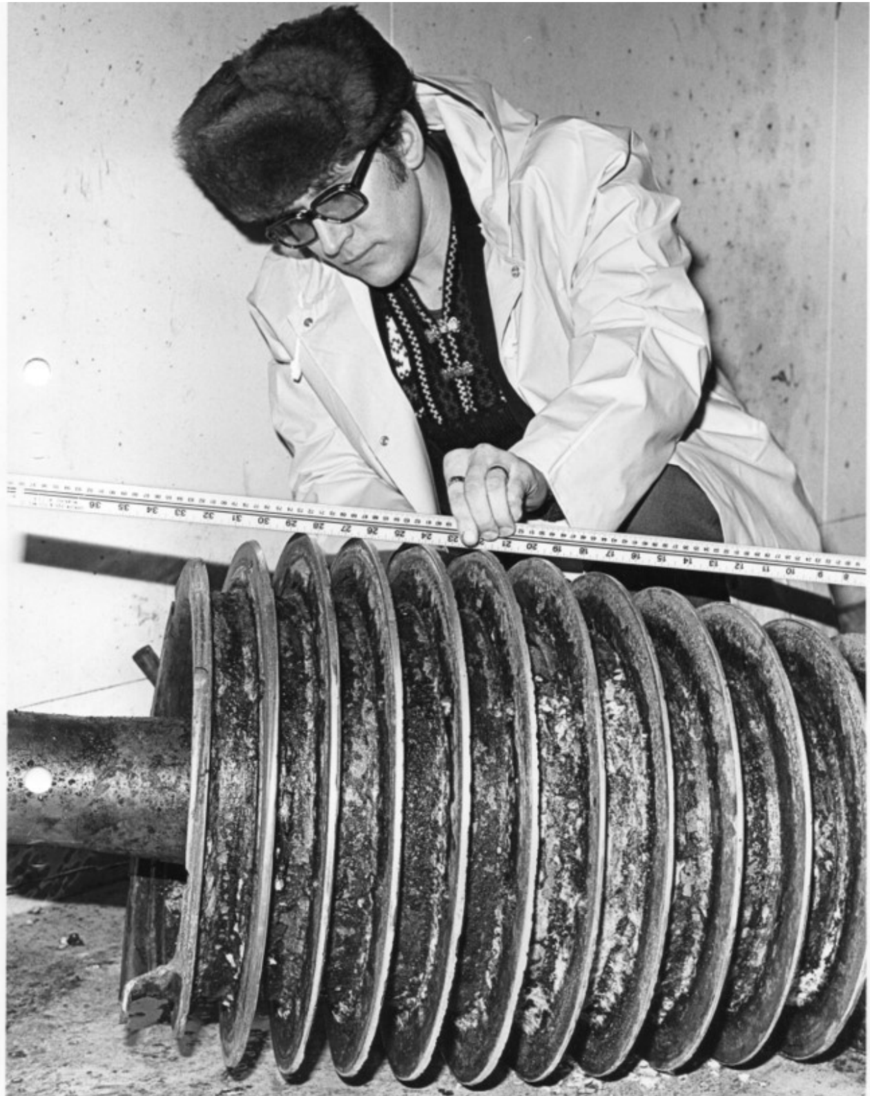
Kuvassa Antti Jouppila mittaa KRUGER-lingon ruuvien kulumaa.
