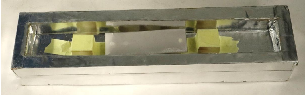
Kuva 15. Punnituksessa käytetty eristelaatikko ilman kantta.
