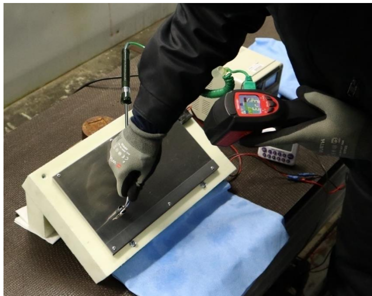
Kuva 16. Lämpötilan mittaaminen K-tyyppin kosketusanturin avulla.
