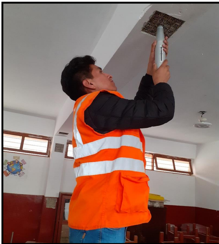
Figura A.8: Ensayo de Esclerometría en el fondo central de la viga.
