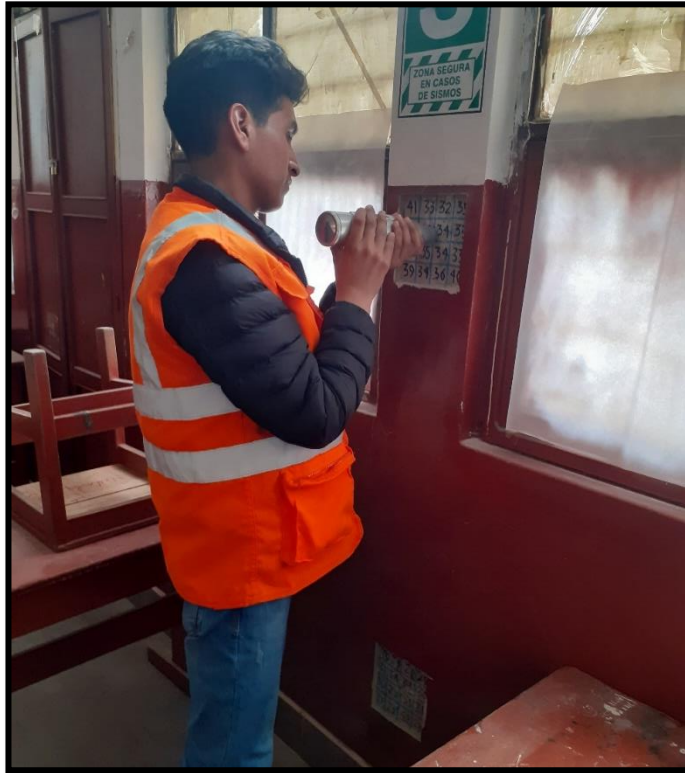
Figura A.5: Ensayo de Esclerometría en la parte central de la Columna.
