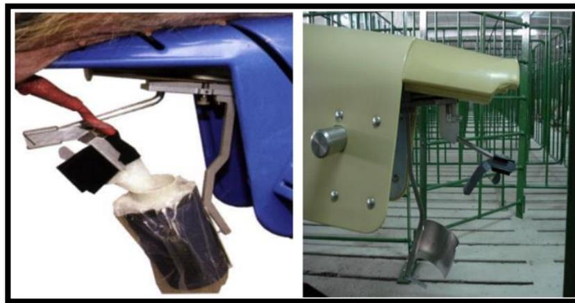
**Figura 5.6. Maniquí para verracos con dispositivo adicional para la recolección automática del semen, AutoMate y cervix artificial.**
