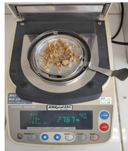
(T) Medición de % humedad de M2 (10% HCM)
