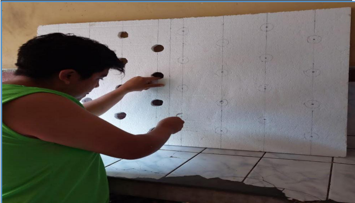
Fotografía 1: Construcción de unidades experimentales del sistema a raíz flotante
