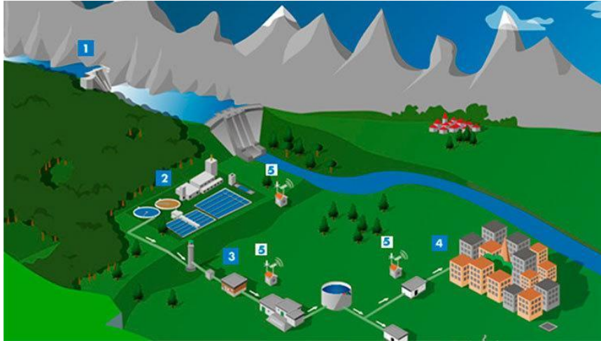
Figura N 3: “Partes de un sistema de abastecimiento de agua potable” Fuente: “ (BSCORPINGENIERIA, 2022)”.
