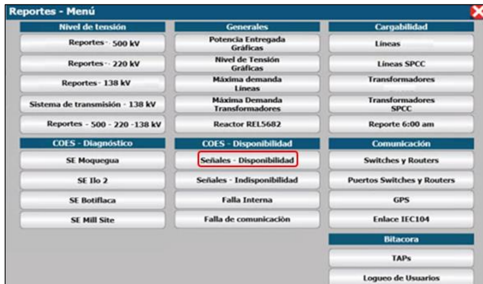
Figura 64. Menú reportes del SCADA Zenon del Centro de Control en la subestación principal. Fuente. Elaboración propia.
