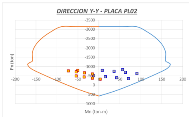
Figura 7.22: Diagrama de Interacción dirección Y-Y Placa PL02
