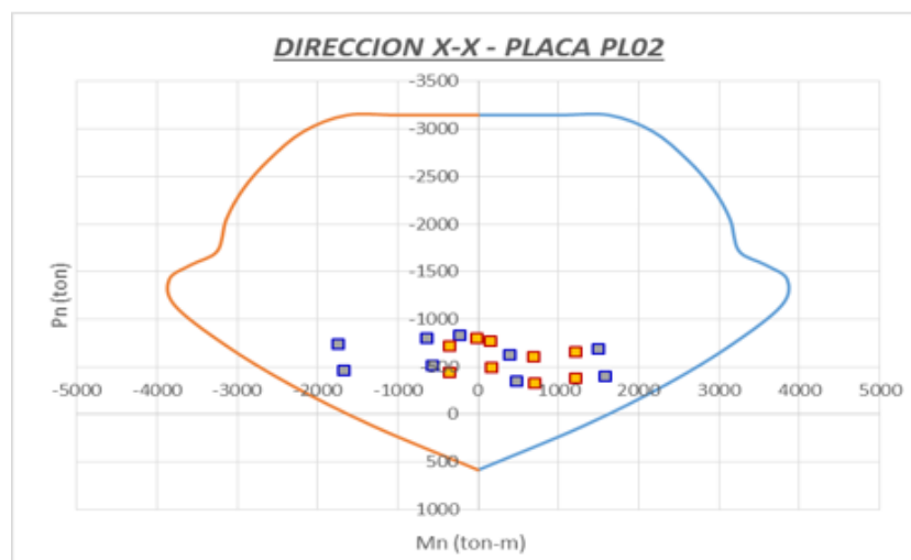
Figura 7.21: Diagrama de Interacción dirección X-X Placa PL02
