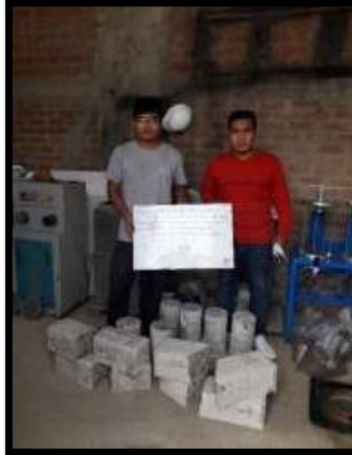
Rotura de Probetas a compresión y flexión del Concreto con 10% y Concreto con 15% de caucho a los 28 días de curado
