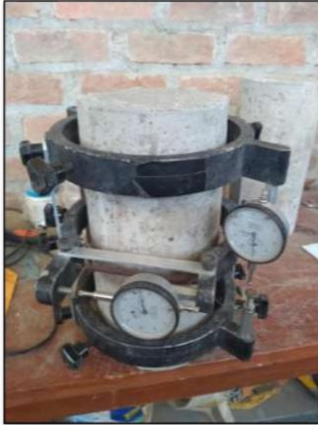
Figura 18: Ensayo de Módulo de Elasticidad
