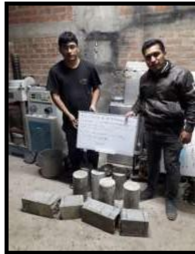
Rotura de Probetas a compresión y flexión del Concreto Patrón y Concreto con 5% de caucho a los 28 días de curado
