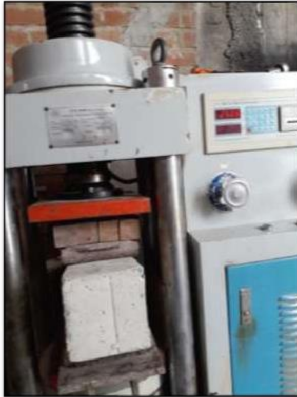
Figura 16: Ensayo de Resistencia a la Flexión
