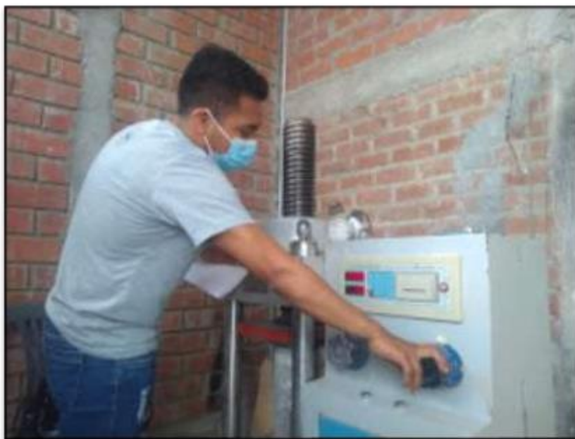
Figura 13: Ensayo de resistencia a la compresión
