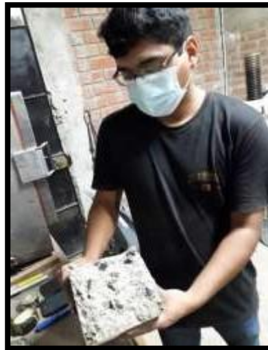
Rotura de Probetas a compresión y flexión del Concreto Patrón y Concreto con 5% de caucho a los 28 días de curado
