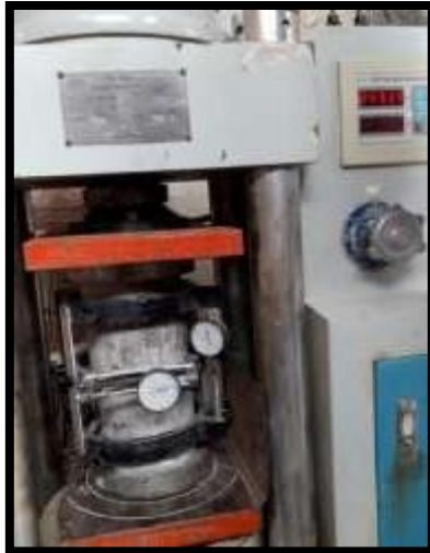
Rotura de Probetas a compresión y flexión del Concreto con 10% y Concreto con 15% de caucho a los 28 días de curado
