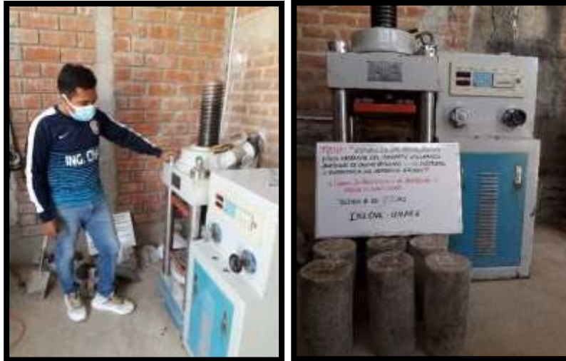
Rotura de Probetas de Concreto Patrón + Concreto con 5% de caucho a los 7 días de curado
