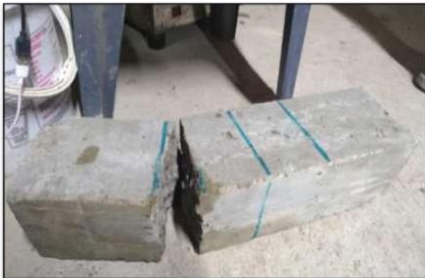
Figura 15: Falla en viga por aplicación de carga central.
