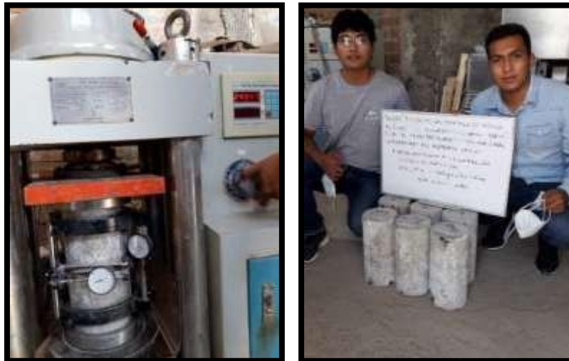
Rotura de Probetas de Concreto con 10% y Concreto con 15% de caucho a los 7 días de curado
