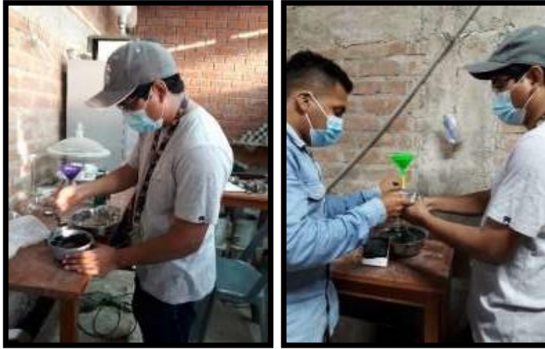
Ensayo para la obtención de la densidad del cemento
