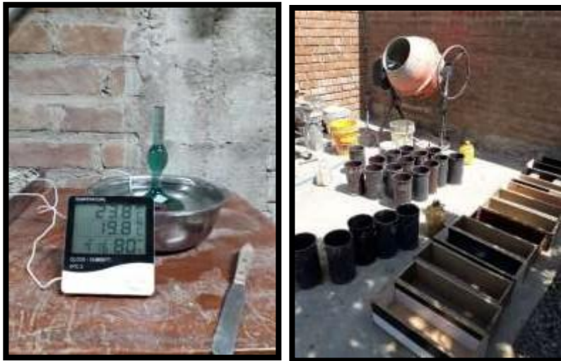
Toma de temperatura y Moldes para la elaboración de testigos de concreto patrón y concreto con caucho incorporado
