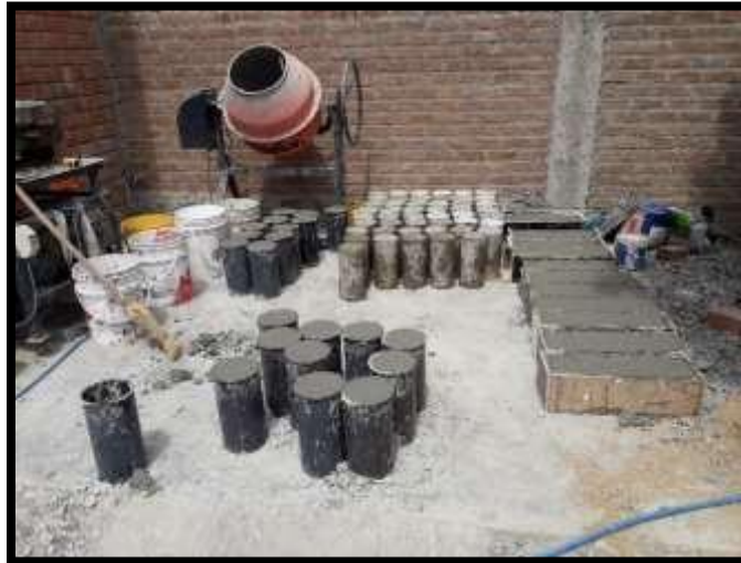
Muestras de testigos de Concreto patrón, Concreto con 5%, 10% y 15% de caucho incorporado
