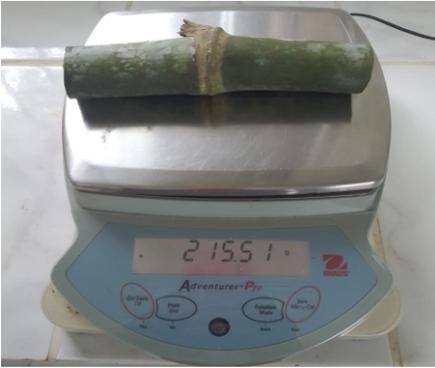
**Foto 31.** Pesado de muestras de parte media del culmo de bambú en laboratorio.
