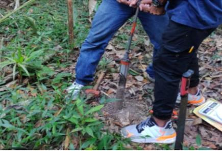
**Foto 21.** Uso del barreno para colecta muestras de suelo para el análisis de COS.
