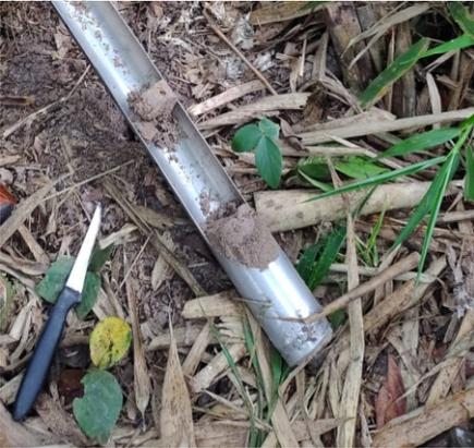
**Foto 23.** Barreno con las muestras de suelo ya extraídas.
