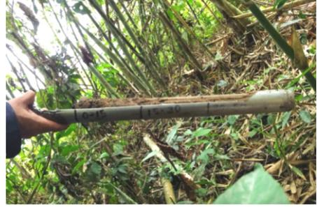
**Foto 22.** Muestra de suelo extraída por el barreno del horizonte del suelo
