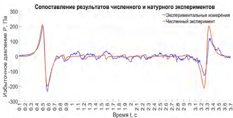
Рис. 16. Сопоставление величин избыточного давления в контрольно-измерительной точке, полученных численно и экспериментально для высокоскоростного электропоезда «Сапсан» на скорости 250 км/ч (расстояние от оси пути 3,1 м, высота над уровнем головки рельса 2,4 м) [выполнено автором].
