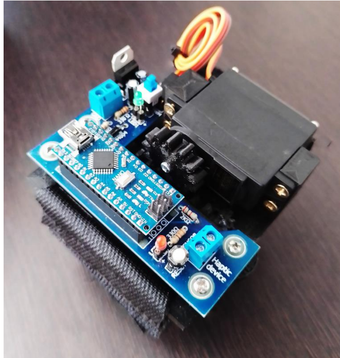
Figura 34: Dispositivo háptico de estiramiento cutáneo longitudinal.
