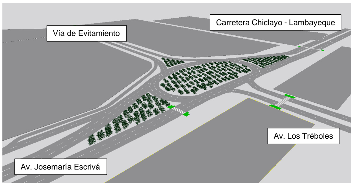
Figura 26 Presencia de las modificaciones del diseño geométrico de dos de las vías colectoras involucradas con el área de estudio
