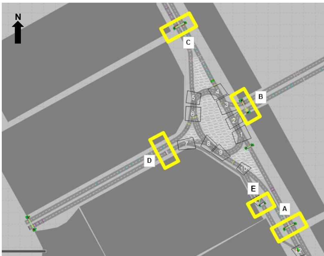
Figura 23 Ubicaciones semafóricas y de cruces peatonales presentes dentro del Óvalo Josemaría Escrivá
