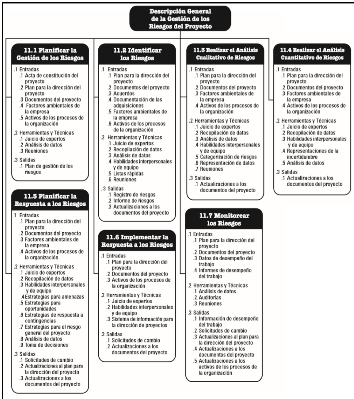
Figura N° 16: Esquema General de la Gestión de los Riesgos del Proyecto Fuente: Extraído de (PMBOK, 2017)
