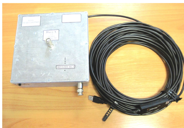
Рис. 12. Внешний вид блока осциллографа и оптоволоконного кабеля
