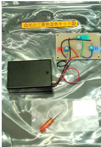
写真1 自作したLED光の三原色混色キット
