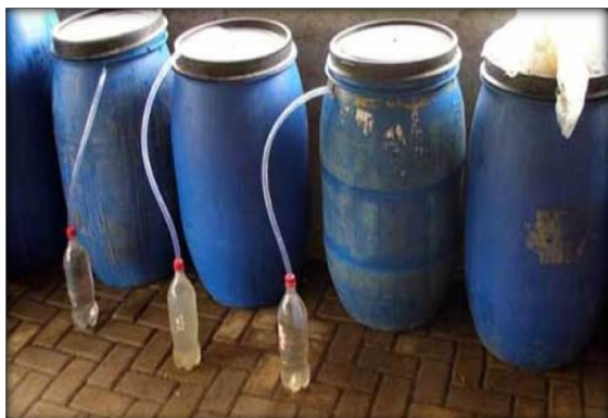
Gambar 1. Desain komposter pembuatan POC
