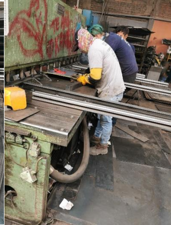
Figura 13: Corte con cizalla
