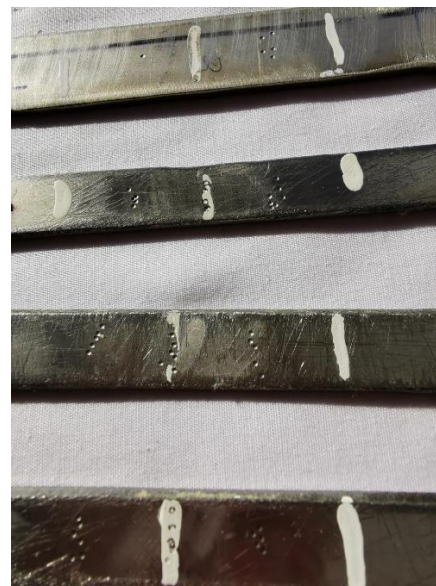
Figura 34: Medición de dureza en las 3 zonas de cada probeta de Ac Inoxidable.
