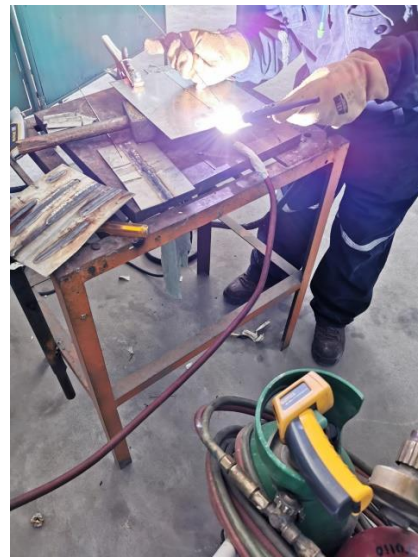
Figura 17: Aplicando la Soldadura TIG
