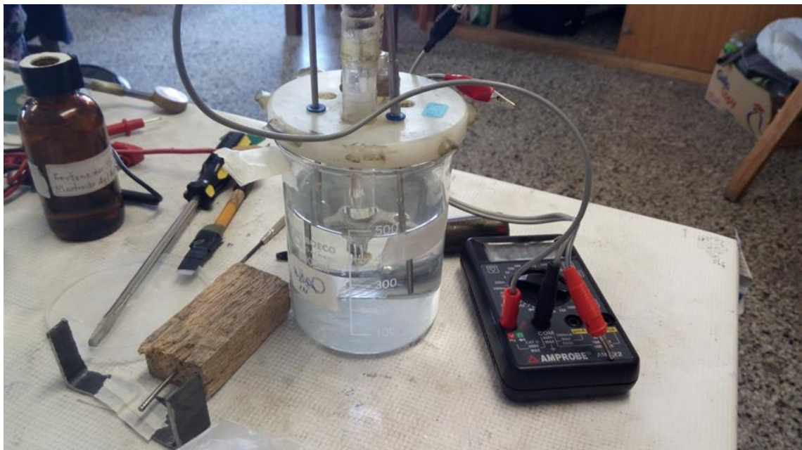
Figura 9: Muestra metálica sumergida en ácido y potenciómetro-
