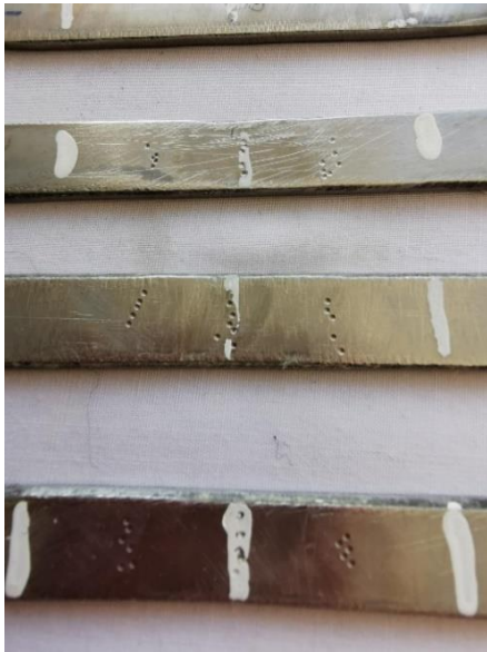
Figura 34: Medición de dureza en las 3 zonas de cada probeta de Ac Inoxidable.
