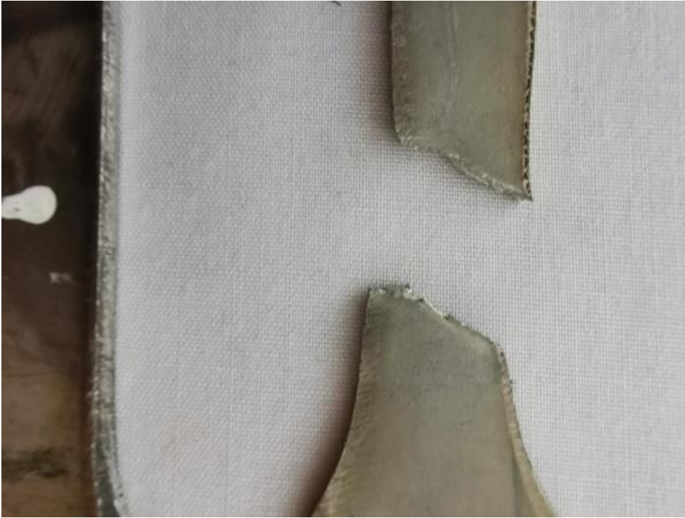
Figura 43: Probeta sin soldadura después del Ensayo de Tracción
