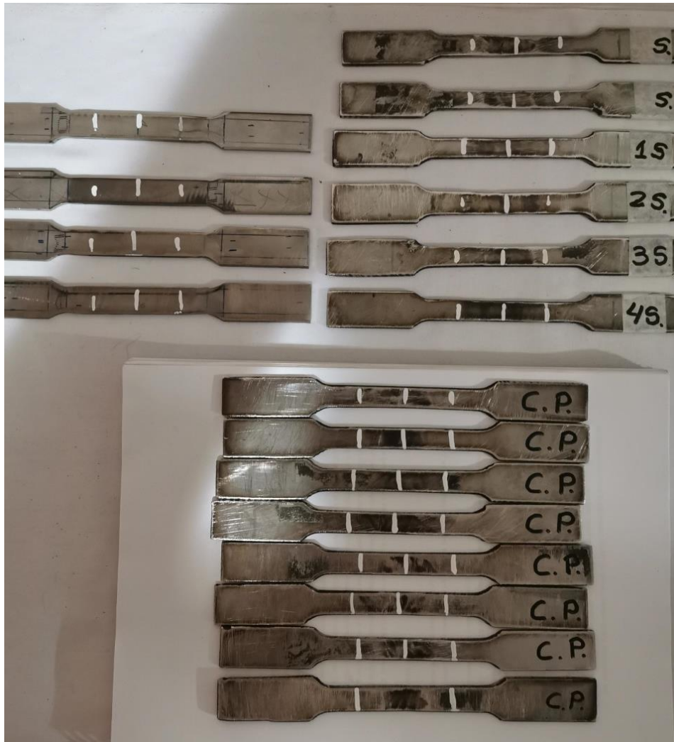
Figura 24: Probetas de Ac. Inoxidable 304 para Ensayos de Tensión y Dureza.
