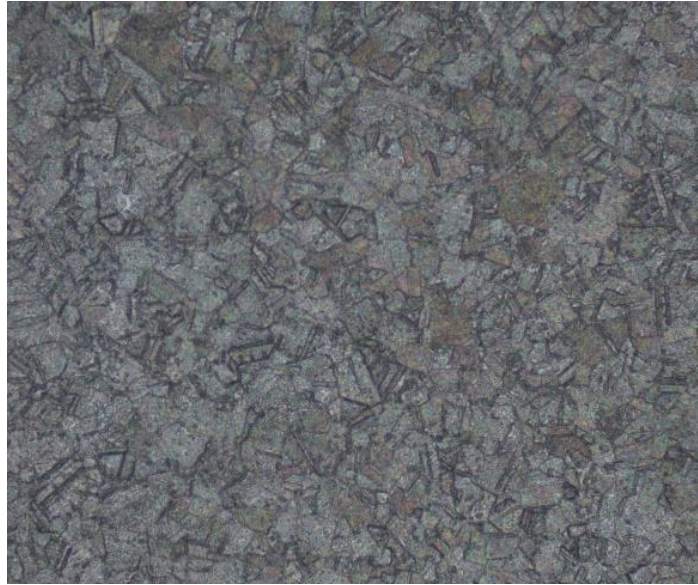
Figura 62: Metal Base Acero 304 a 200x
