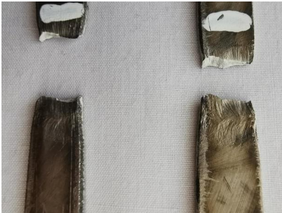
Figura 43: Probeta sin soldadura después del Ensayo de Tracción
