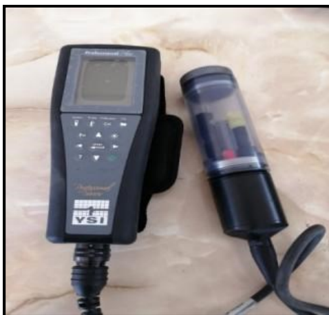
Figura No. 3: Multiparámetro YSI usado para la medición de calidad de agua el equipo pertenece al proyecto UNSA – PURDUE
