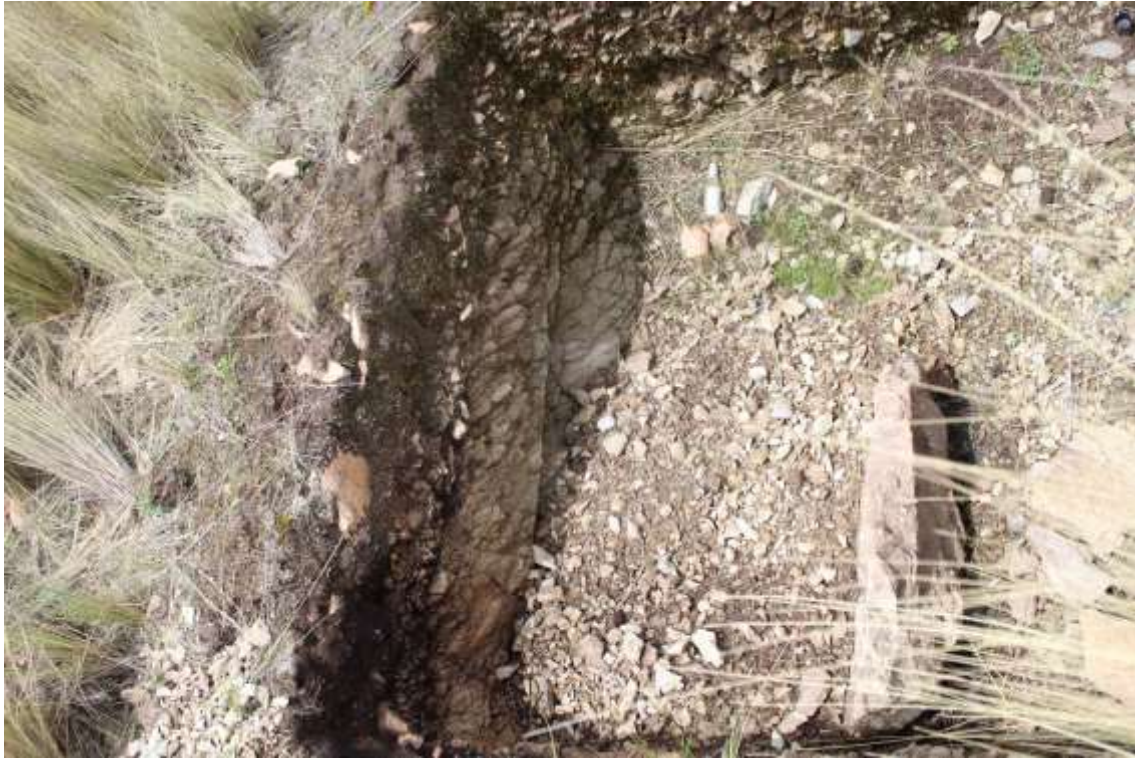
Fotografía 25: Calicata en la cima del cerro Curi mostrando la litología granodiorita.
