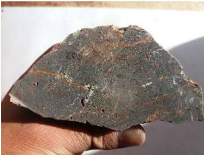
Fotografía 62: Muestra de mano de magnetita con fracturas con relleno de óxidos de hierro.
