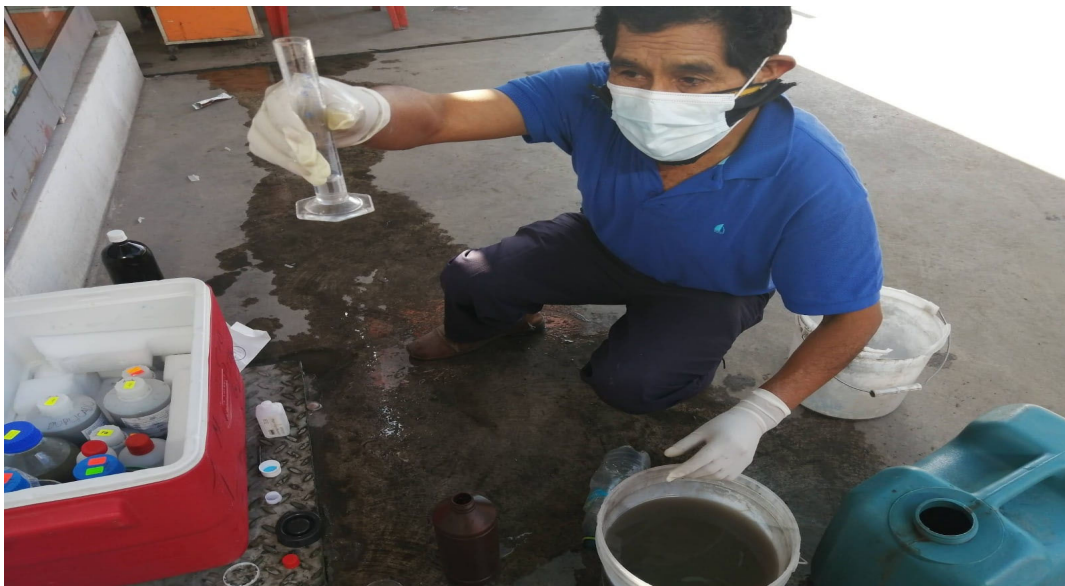
Figura 66. Adición de preservante a muestra de agua residual para (A y G)
