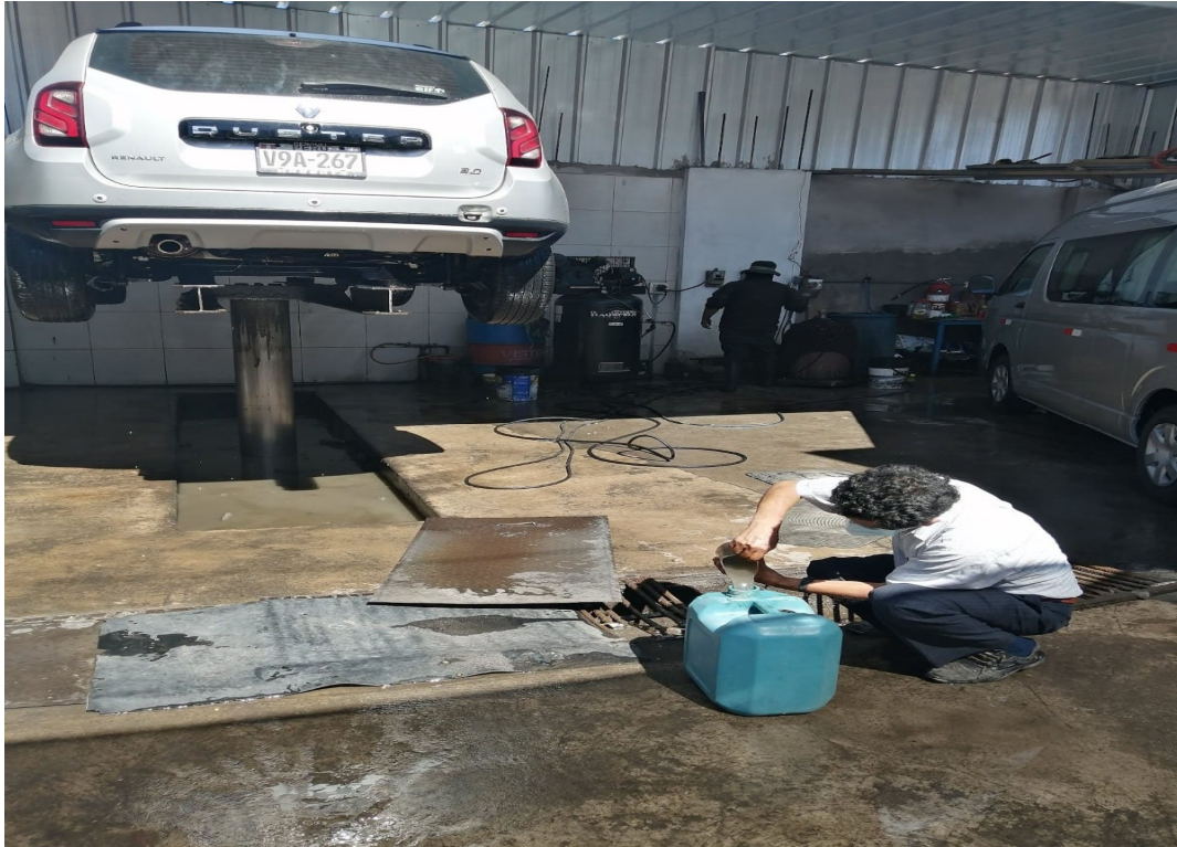
Figura 63. Toma de muestra de canal de evacuación de agua residual
