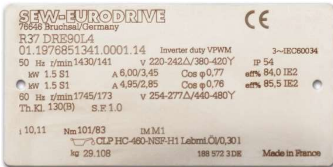
Figura 33. Placa típica de un motorreductor marca SEW Eurodrive.
