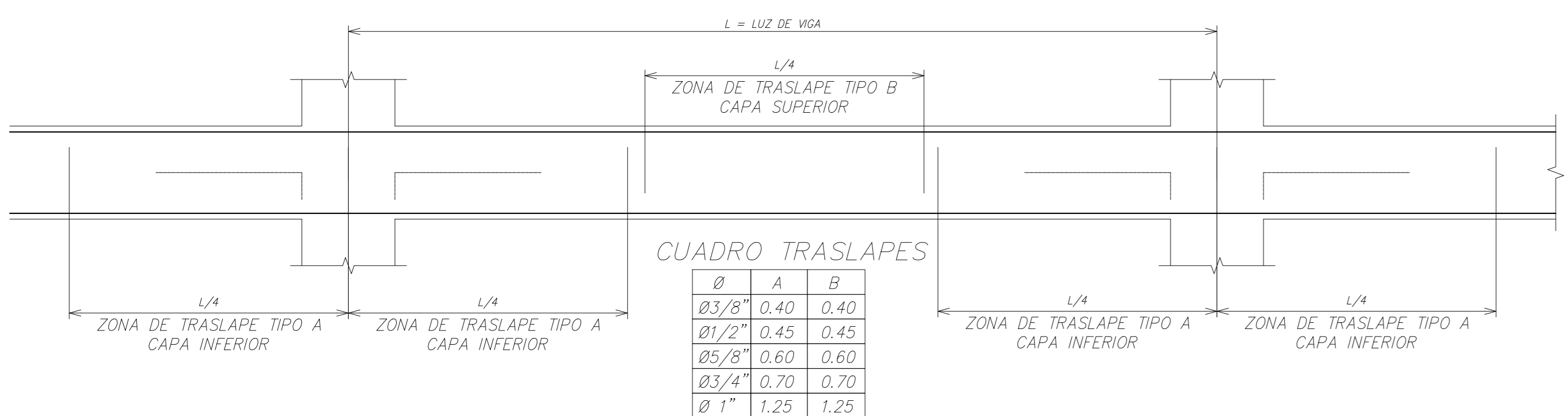
DETALLE DE TRASLAPES PERMITIDOS EN VIGAS (escala 1:25)
