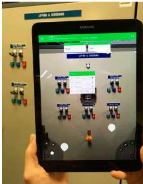
Figura 2 Vista desde Tablet de Realidad Aumentada (Schneider Electric, 2020).
