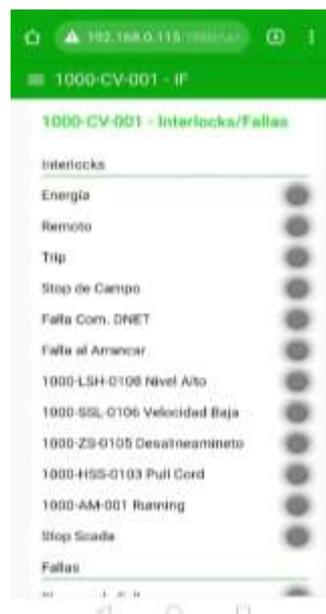
Figura 100 Vista desde el celular del acceso a los interlocks y fallas del equipo de la Escena 1000-CV-001.
