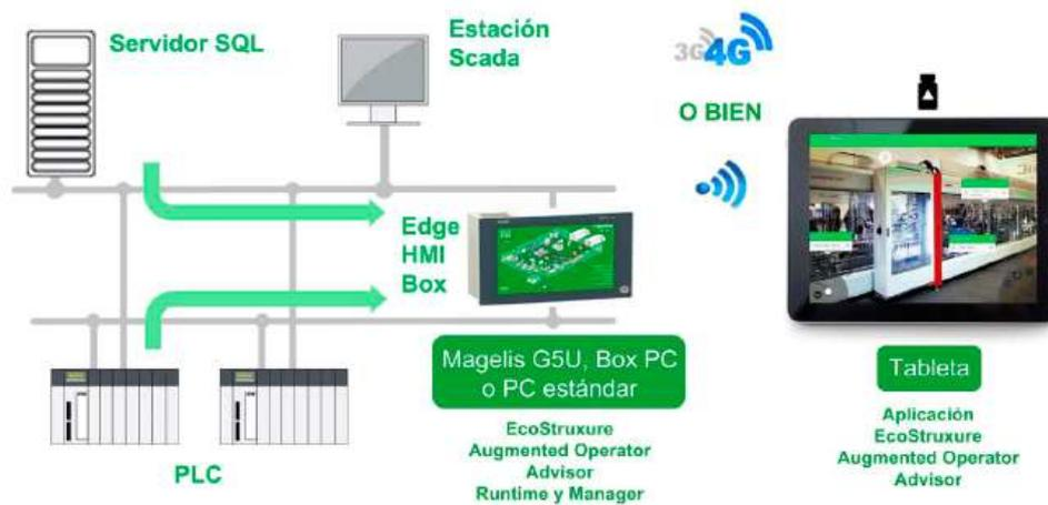
Figura 3 Arquitectura general para la Realidad Aumentada (Schneider Electric, 2020).
