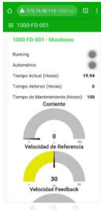
Figura 149 Vista desde el celular del acceso al Monitoreo de variables del equipo de la Escena Módulo PowerFlex 40.
