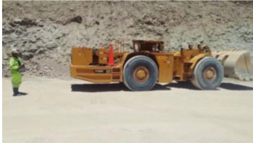
Foto 3.09 Scoop operado con telemando.
