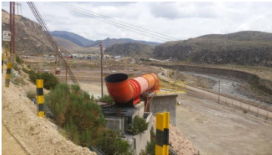
Foto 3.06 Ventilador en superficie
