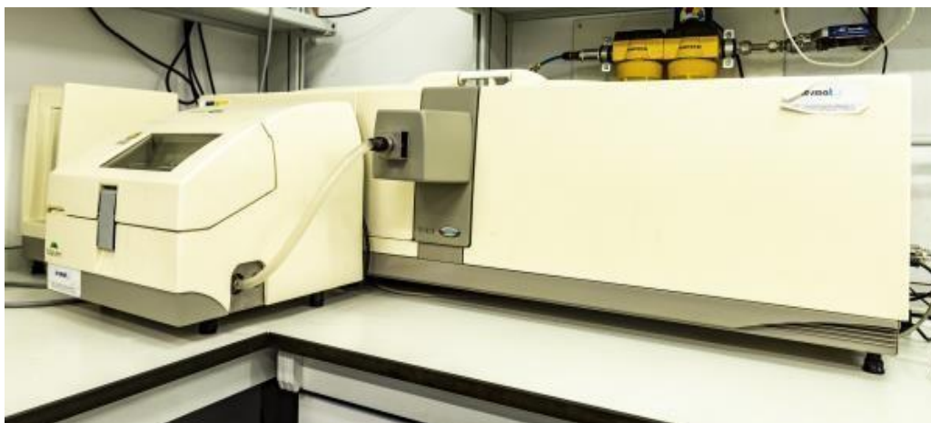
Figura 24. Equipos de difracción láser de luz Mastersizer 2000 (Malvern Instruments) (Universidad de Sevilla-España).
