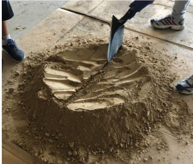
Figura 15. Proceso de homogeneización de muestra de relave formal e informal.
