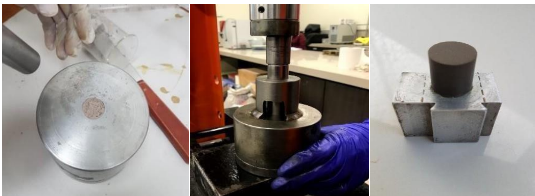
Figura 20. Proceso de moldeado de pasta plástica
