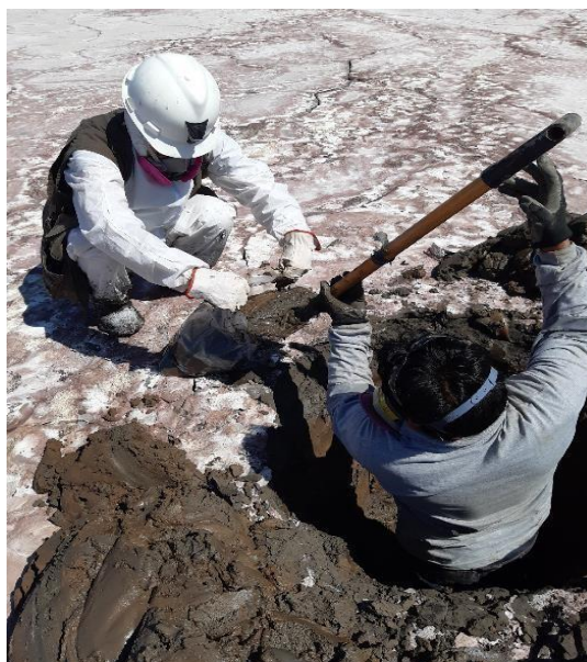
Figura 8. Muestreo por canales y recolección de la muestra
