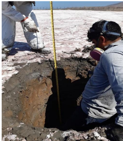
Figura 7. Medición de la profundidad para el muestreo por canales.
