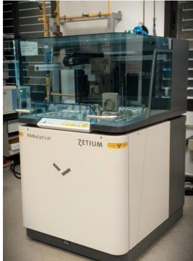
Figura 28. Fotografía del espectrómetro de fluorescencia de rayos x, marca PANalytical, modelo ZETIUM Minerals (Universidad de Sevilla)
