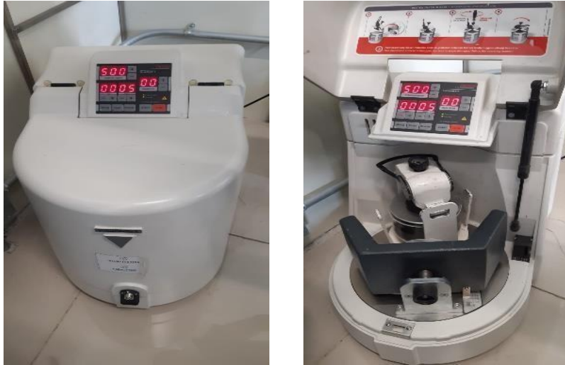
Figura 17. Proceso de molienda de muestras de relave y arena fina Nota: La figura muestra el equipo empleado para la molienda de la arena.
