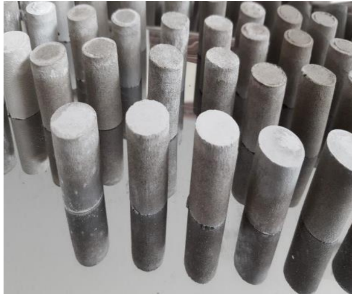
Figura 21. Muestras cilíndricas luego del proceso de curado
