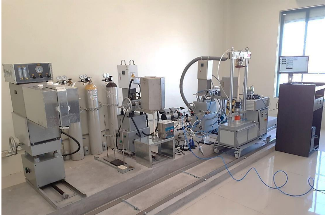
Figura 37. Sistema integrado para la evaluación mecánica de materiales en compresión uniaxial y condiciones variables de temperatura y atmosfera (Universidad Católica San Pablo)
