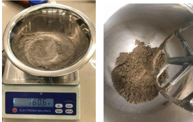
Figura 18. Proceso de medida de masas y mezclado en seco
