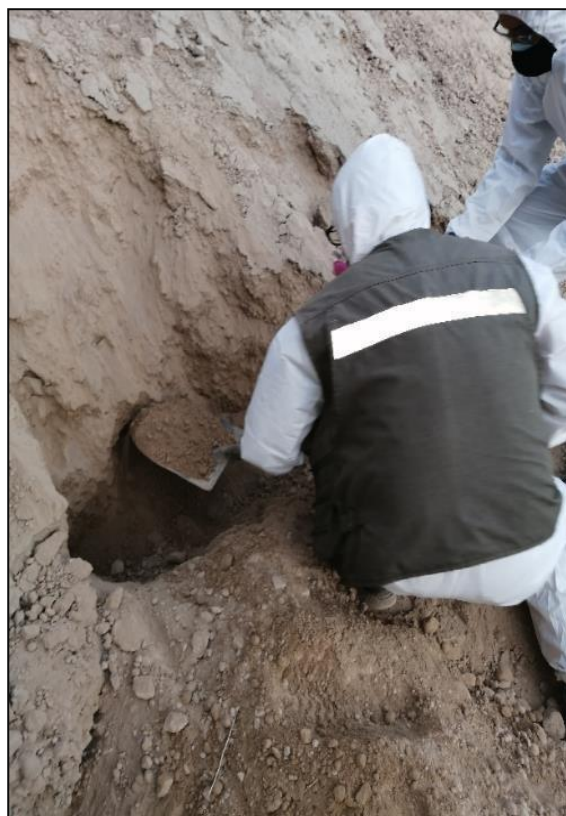
Figura 11. Remoción de relave para la toma de muestra de minería informal Nota: Excavación de una calicata empleando pico y la pala.
