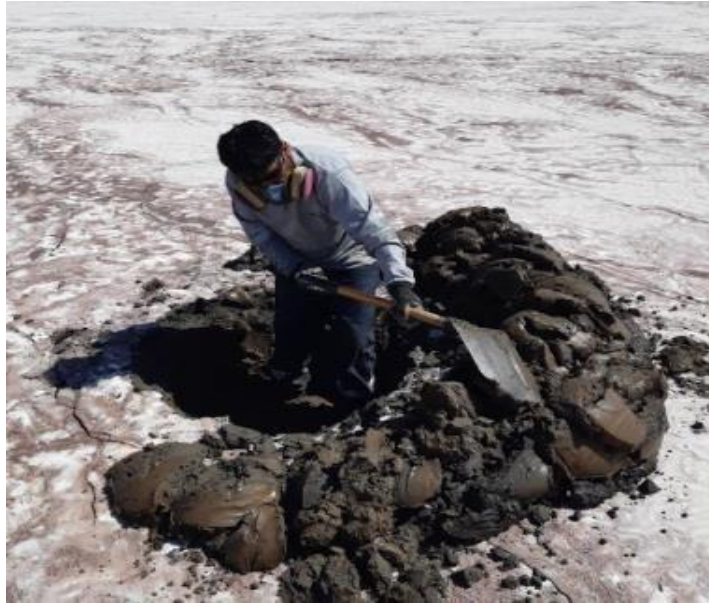
Figura 6. Procedimiento de excavación para toma de muestra
