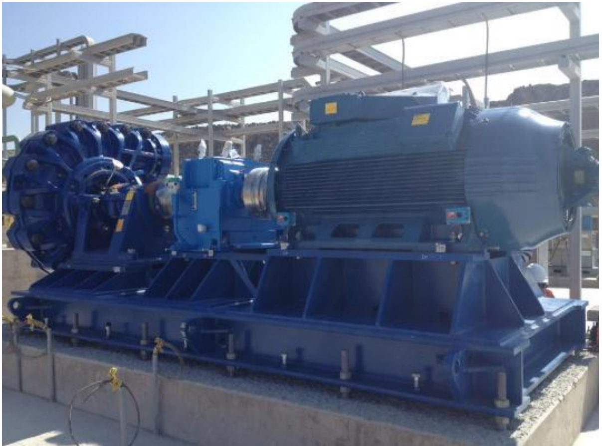
Figura 11: Bomba de Arena SMCV-Linga
