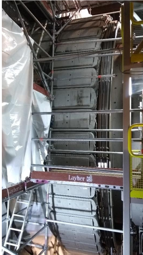
Figura 25. Motor anular con estator desplazado, polos libres - Molino 201 C1[Elaboración propia]
