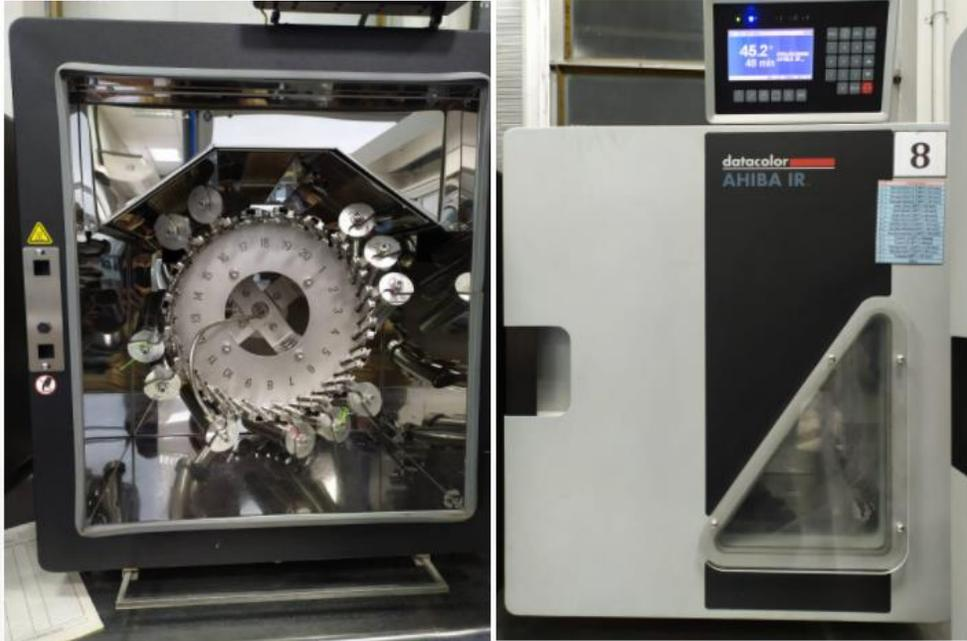
**3.1.6.2) Tubos para la Prueba de teñido.** Son 15 tubos de acero inoxidable que se incorporan en un tambor en la máquina de teñido, resistentes a la presión y altas temperaturas requeridas para las pruebas de teñido.
