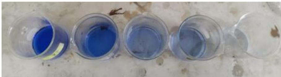
Después de medir el blanco (agua de uso textil), se colocó la cubeta con la disolución 5 (la más concentrada) y se midió la absorbancia en el intervalo de longitudes de onda fijado según bibliografía tomando valores cada 20 nm. Se repite la experiencia de manera más fina en la zona donde se observe una mayor absorbancia, esta vez tomando valores cada 10 nm.
