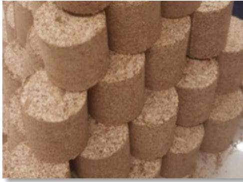
Figura 10. Aserrín compactado para proceso de pirolisis
