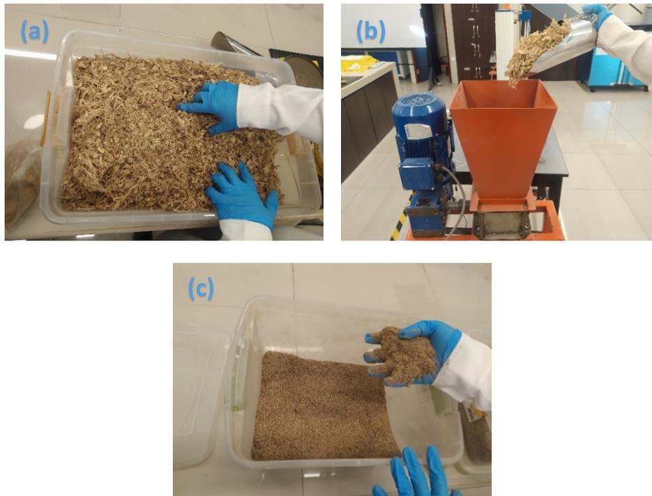
Figura 22. Procesos de eliminación de residuos/secado (a), reducción de tamaño de residuos (b) y residuos triturados (c)
