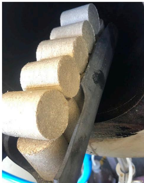
Figura 11. Crisol de alúmina con aserrín compactado previo al inicio de la pirolisis
