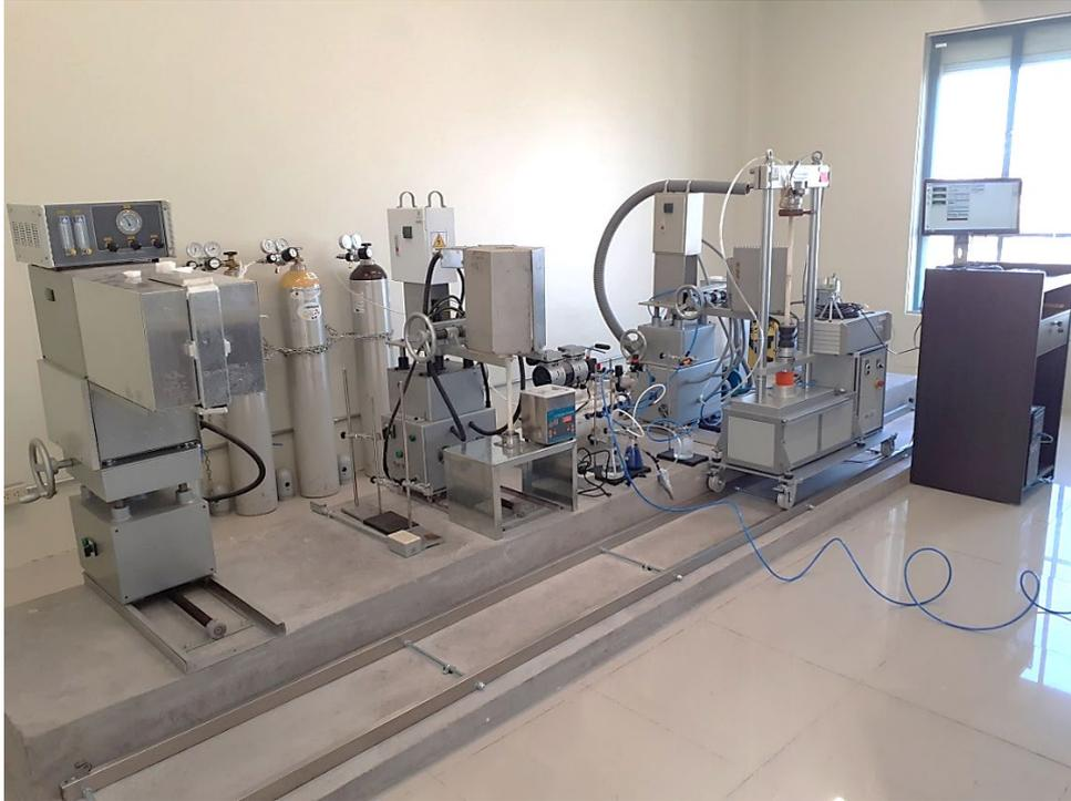
Figura 48. Sistema integrado para la evaluación mecánica de materiales en compresión uniaxial y condiciones variables de temperatura y atmosfera
