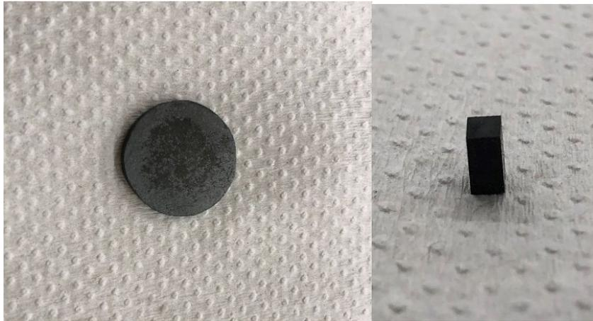
Figura 46. Etapas para la obtención de paralelepípedos: (a) aspecto macroscópico de una probeta de geometría circular, (b) paralelepípedos obtenidos luego de cortes perpendiculares a la sección transversal.
