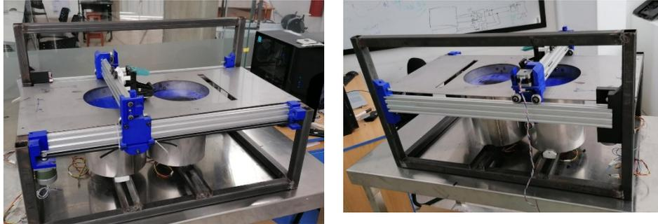
Figura 28. Impresora 3D de polvo cerámico usado en este trabajo
