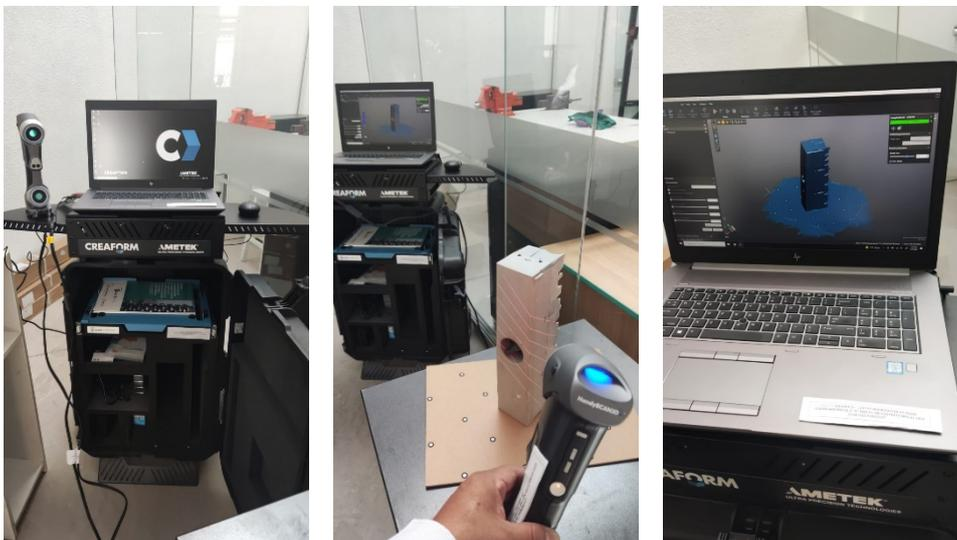
Figura 21. Escáner 3D marca ENVAL, modelo Handyscan 307 y procedimiento de escaneamiento.
