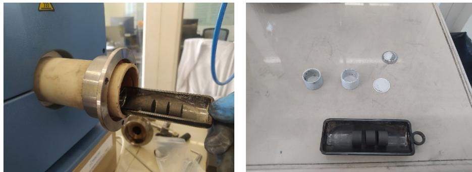
Figura 29. Preformas carbonosas luego de la eliminación de la resina aglutinante.
