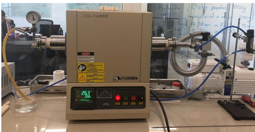
Figura 19. Horno tubular para infiltración en funcionamiento
