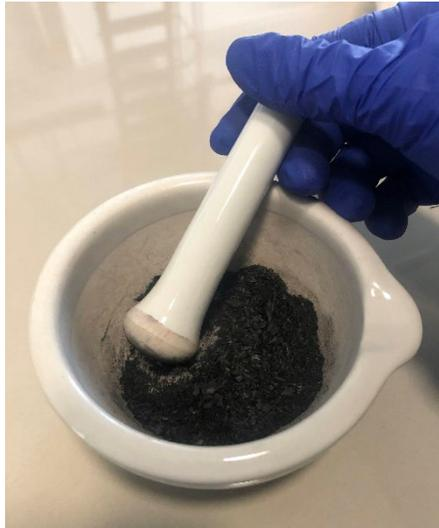
Figura 16. Proceso de mezclado de polvo de carbón con resina fenólica
