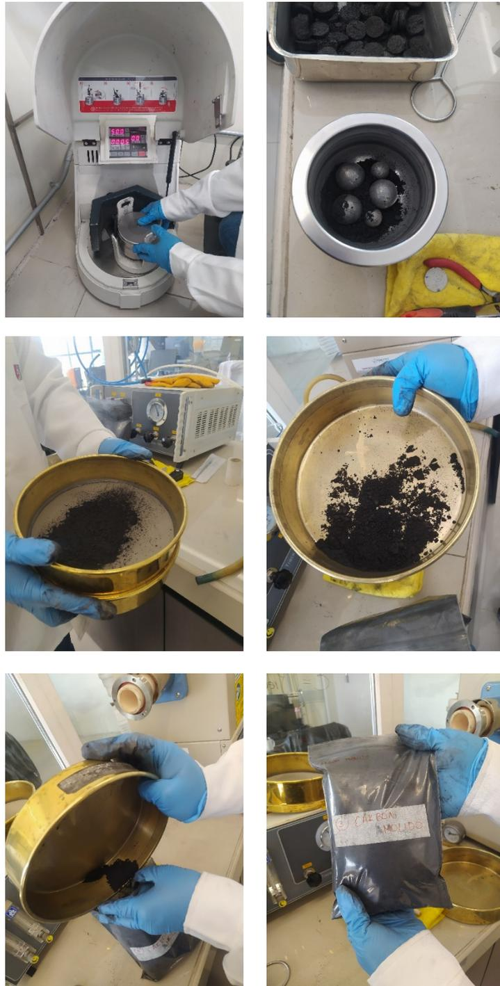
Figura 27. Proceso de molienda, tamizado y embolsado de polvo de carbón.
