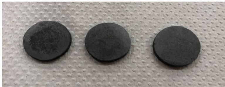
Figura 20. Discos de carburo de silicio después del pulido
