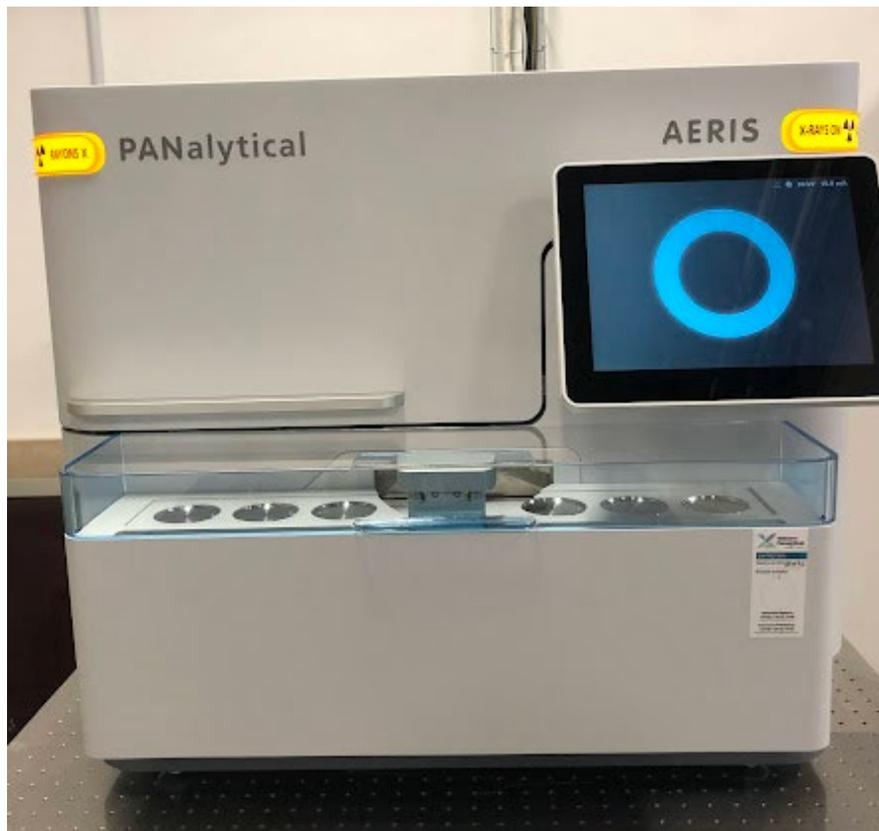
Figura 37. Fotografía del difractómetro de rayos X
