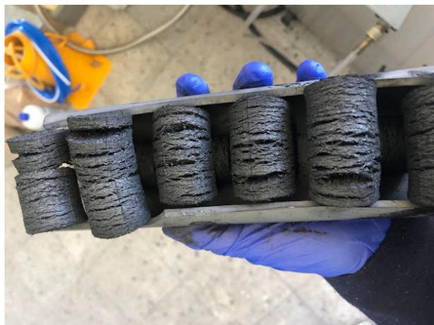
Figura 12. Carbón obtenido mediante pirolisis
