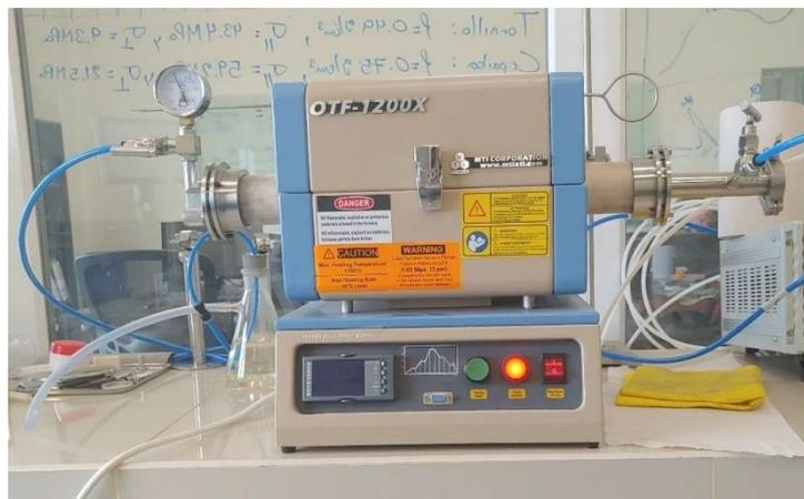
Figura 9. Horno tubular para pirólisis en funcionamiento.
