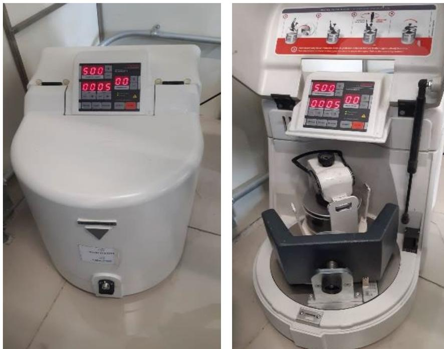
Figura 14. Proceso de molienda de muestras de carbón
