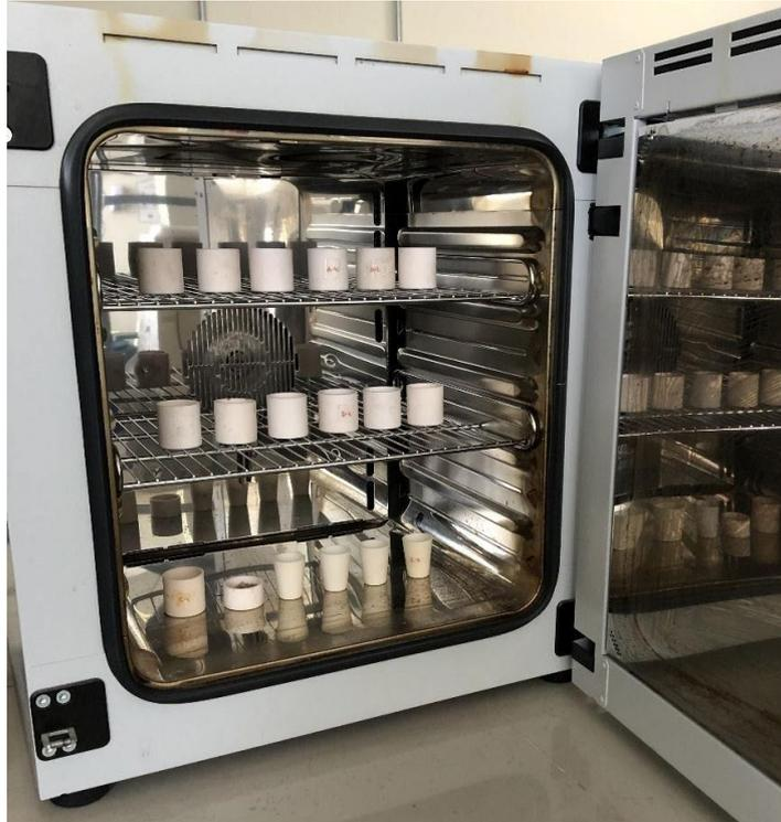
Figura 33. Secado de probetas.
