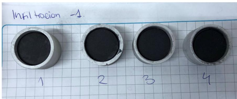
Figura 18. Crisoles con preformas de carbón
