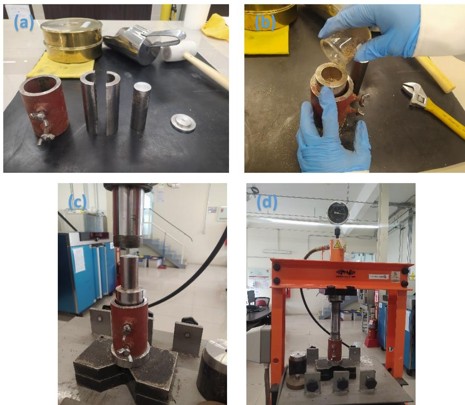
Figura 24. Proceso de prensado para la obtención de briquetas de polvo de aserrín
