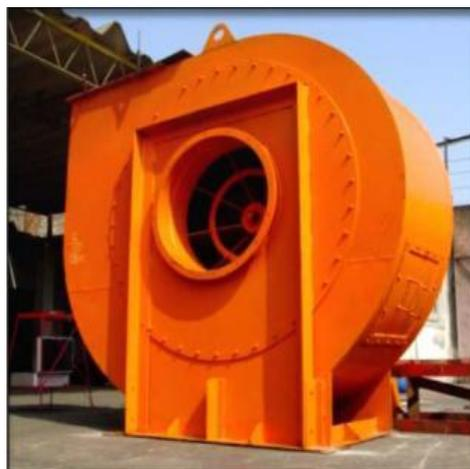
*Figura Nº 9: Ventilador centrífugo
