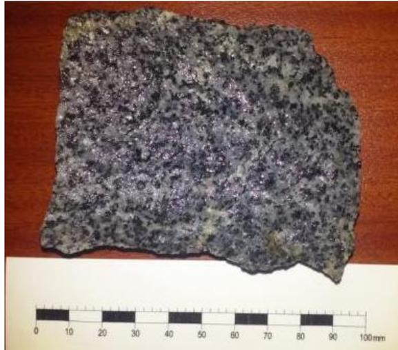
*Figura N° 16: Granodiorita de Bypass 7681 Nv.570.
