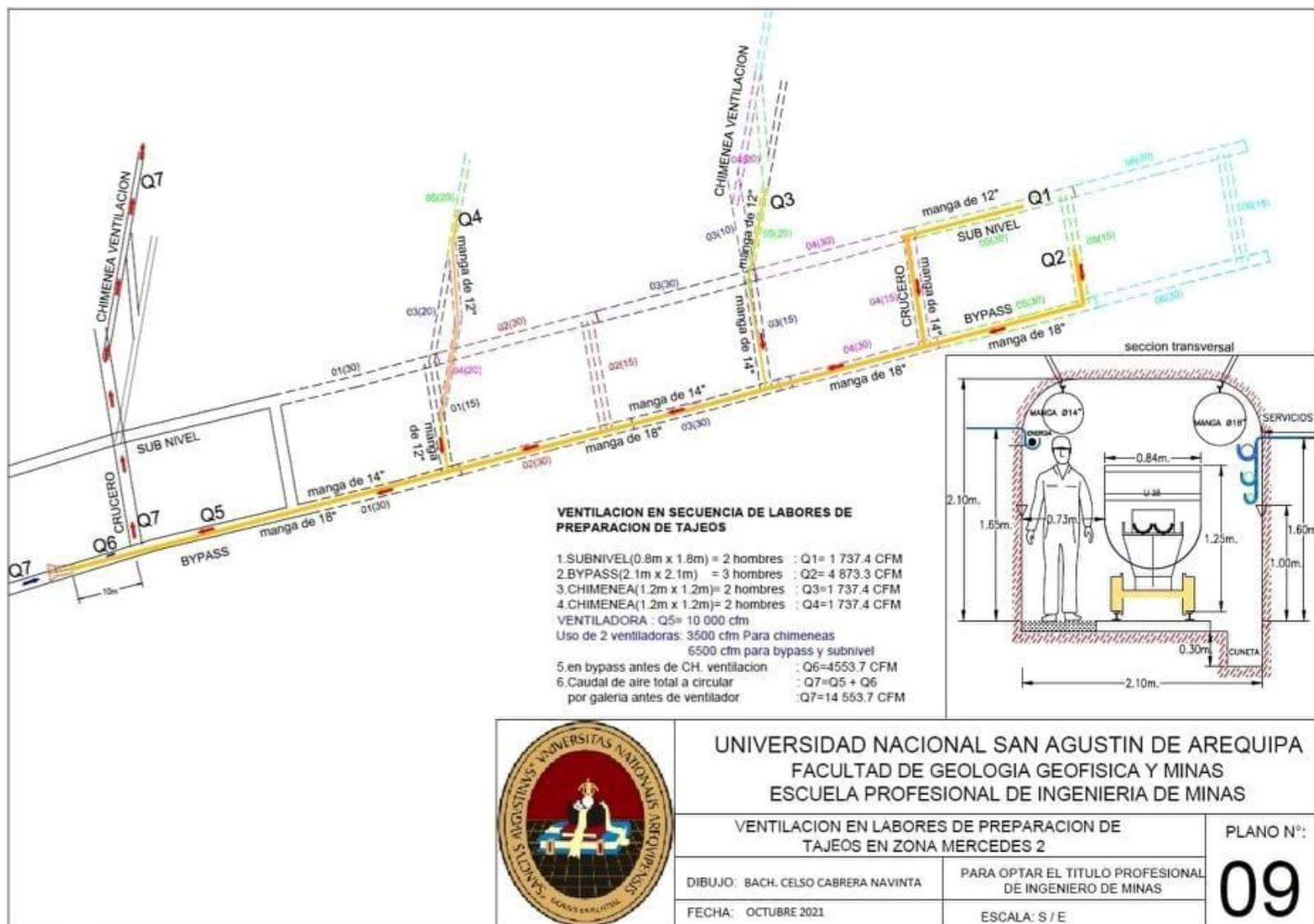
Figura N° 69: Plano de diseño de ventilación auxiliar para labores de preparación de tajeos.
