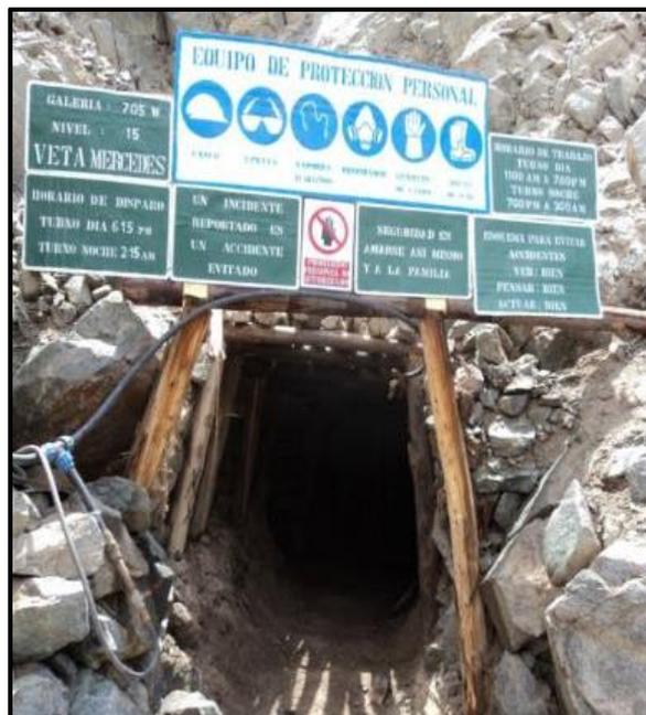
Figura N° 59: Salida actual de aire en Nv.15
