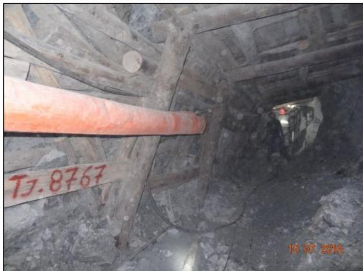
*Figura N° 67: Ventilacion auxiliar en tajeos
