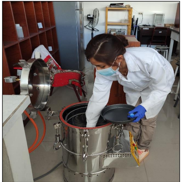
Figura 29 Retiro de muestras de suelo del proceso de autoclave.
