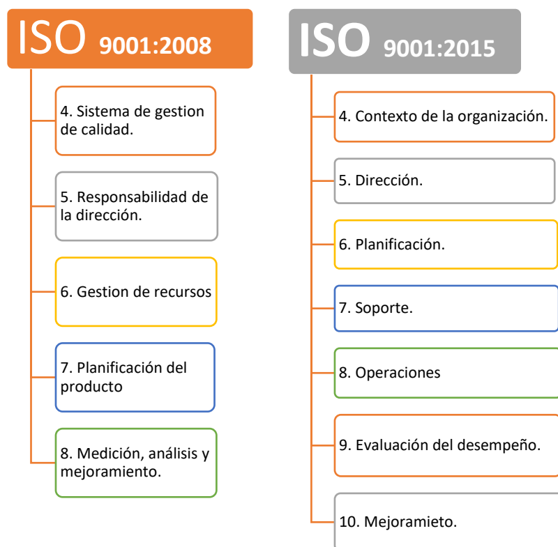
Figura 2.04 Comparación de la estructura versión 2015 y 2008 de la Norma ISO 9001.
