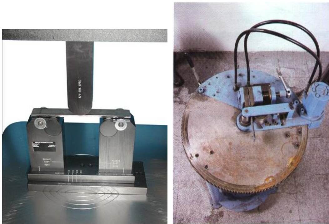
Figura 4.55 Doblado Guiado con equipo de Rolado y por Enrollado
