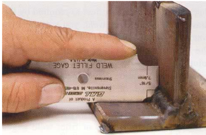
Figura 4.34 Uso de Galga tipo patrón para filete en la Inspección Visual
