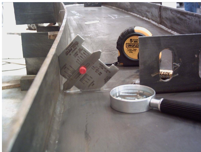
Figura 4.33 Uso de herramientas para la Inspección Visual de la Soldadura.
