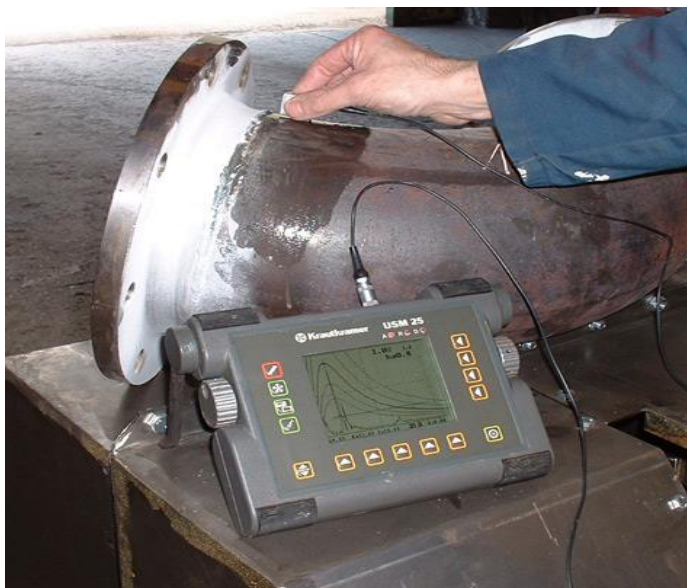
Figura 4.48 Inspección por Ultrasonido de una junta soldada
