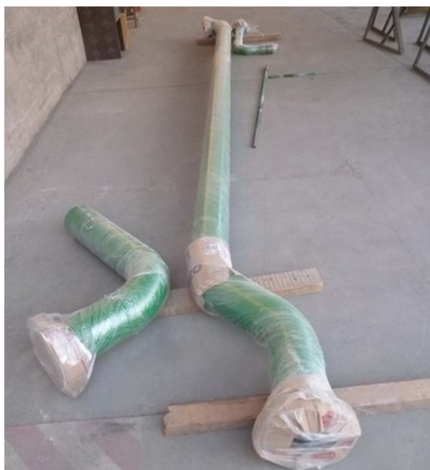
Fig. 26- Embalaje de componentes de tuberías fabricados.
