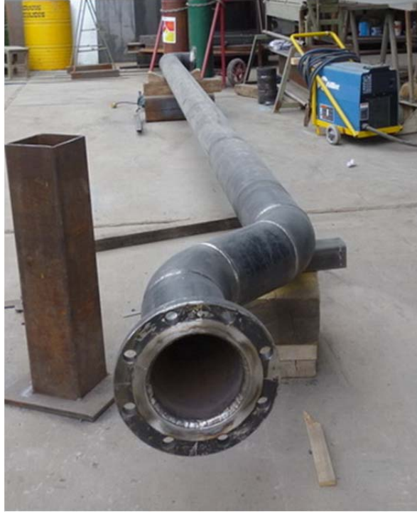
Fig. 20- Armado de tubería de rebose.
