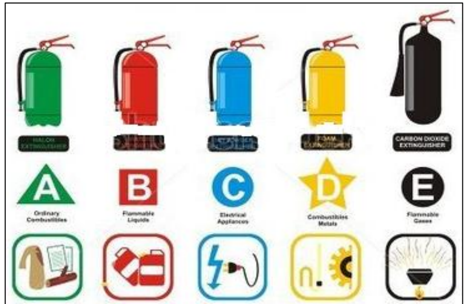
Figura 14: Extintores según Utilidad
