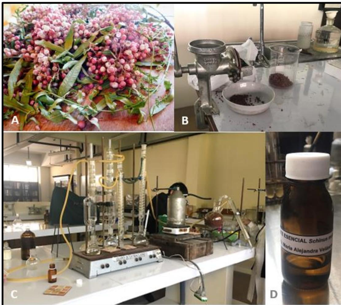
**Fig 3.** A. Selección de frutos de *Schinus molle* L. B. Triturado de los frutos en un molino. C. Equipo de extracción tipo Clevenger, para la obtención del aceite esencial por arrastre de vapor de agua. D. Frasco esmerilado el cual contiene el aceite esencial obtenido. (Fuente: Elaboración propia)
