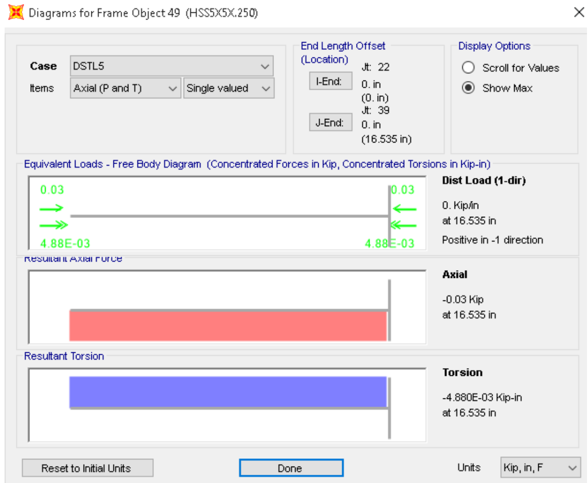
Imagen 32. Carga factorizada del elemento 49. Fuente: Elaboración propia.
