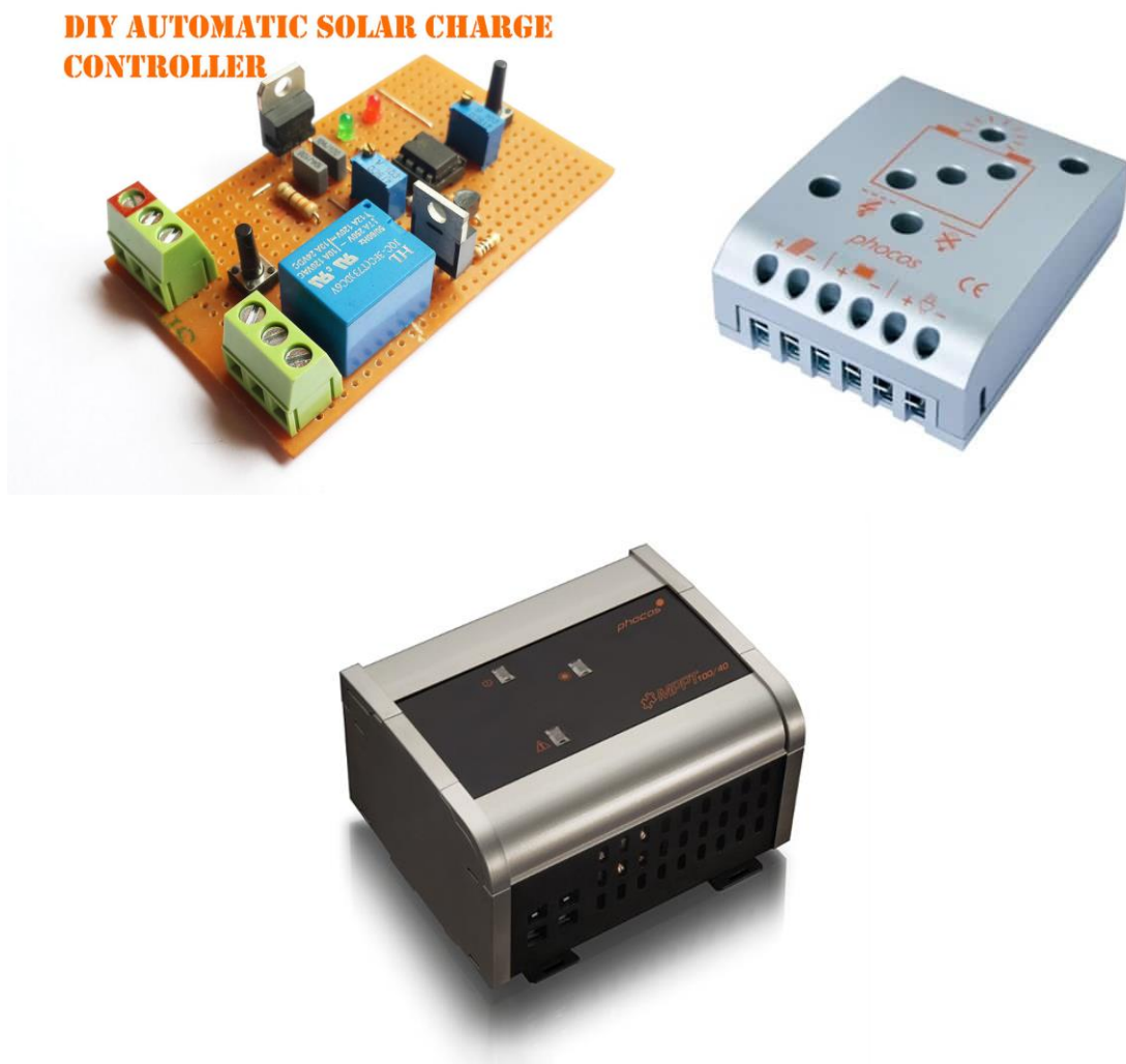
Figura 23 Tipos de controlador solar. (a) 2 etapas, (b) PWM y (c) MPPT.
