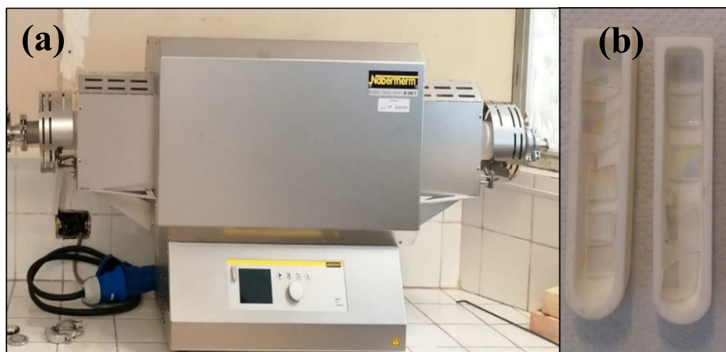
Figura 3.8. (a) Horno tubular para tratamientos térmicos. (b) Barquito de crisol de alúmina para colocar las películas dentro del horno para ser tratadas térmicamente.
