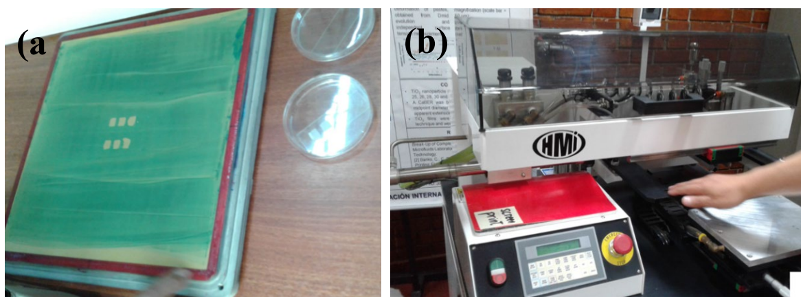
Figura 3.2 (a) Pantalla donde se encuentra el patrón a imprimir. (b) Equipo de screen printing .
