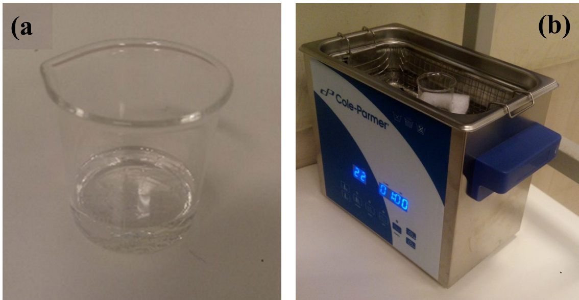
Figura 3.3. (a) Sustratos dentro de un vaso de pirex con alcohol isopropílico. (b) Limpieza de los sustratos con una limpiadora ultrasónica con temporizador.
