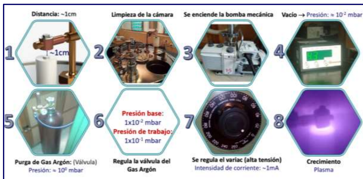
Figura 17. Procedimiento para el crecimiento de las películas delgadas y/o gruesas de \text{SnO}_2 dopadas con Fe.
