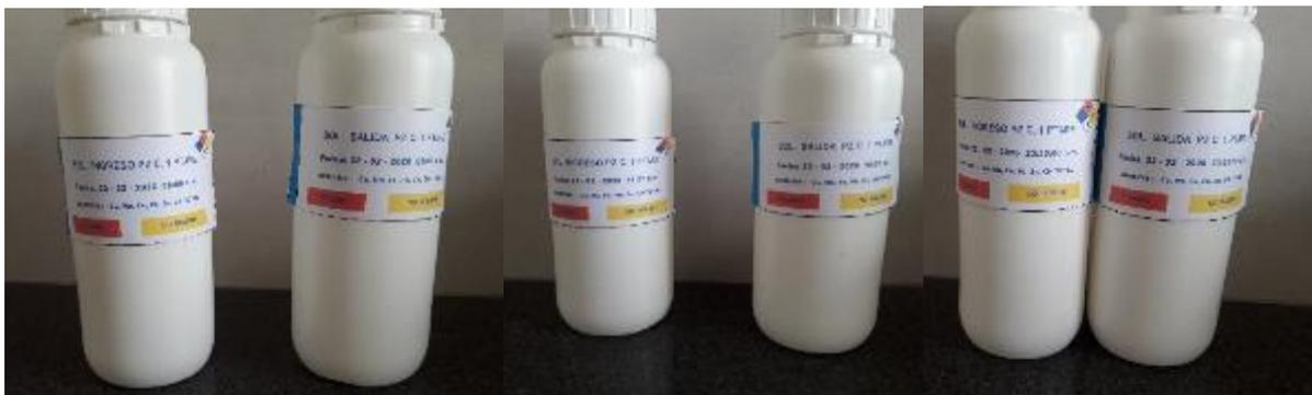
IMAGEN N° 4.4: Muestras de Ingreso Y Salida Día 1 De Pruebas de Tratamiento de Flujo De 50 M3/h en PTARE Fuente: Elaboración Propia
