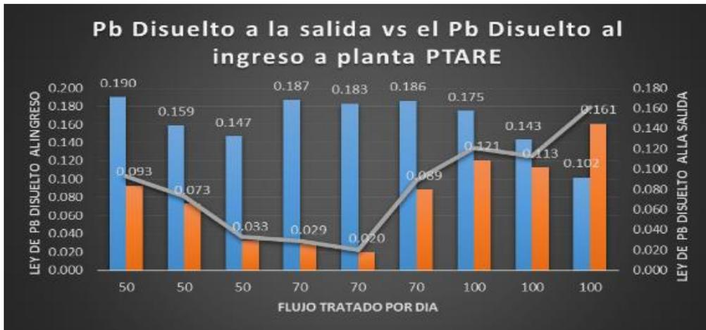
GRAFICA N° 4.28: Leyes de Plomo disuelto al ingreso al tratamiento (mg/l) vs Leyes de Plomo disuelto a la salida del tratamiento (mg/l) - Fuente: Elaboración Propia
