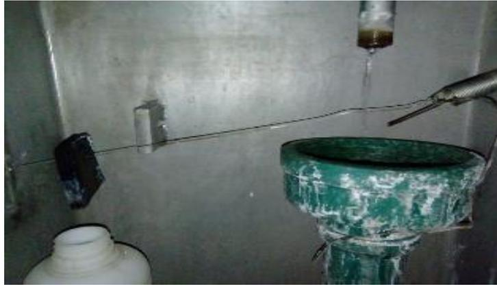
IMAGEN N° 4.3: Muestreador de solución de salida de planta (ubicado en al finalizar el tratamiento de PTARE) Fuente: Elaboración Propia
