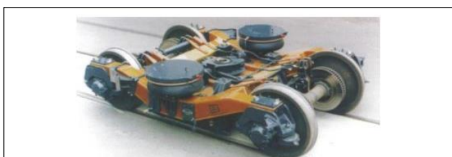
Ilustración 14 Prototipo de Bogie con materiales compuestos. Fuente: (Kahnert, 2015)
