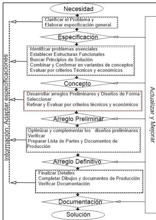
Ilustración 6 Estructura de Diseño según Pahl & Beitz Fuente (Romero, 2015)
