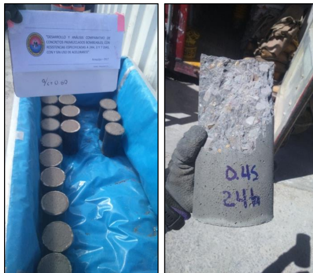
Figura 4-12 curado inicial de probetas - rotura de probeta a las 24 horas
