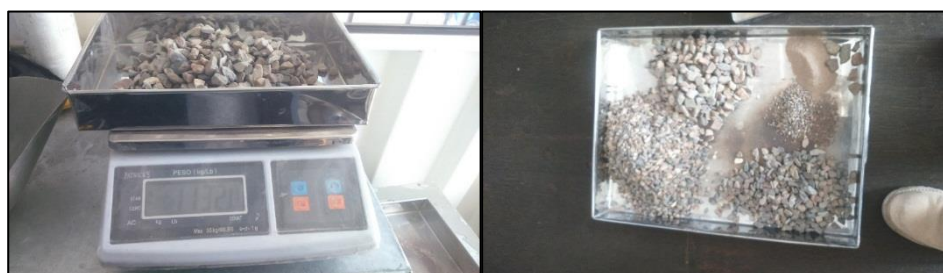
Figura 2-8 Ensayo de Análisis Granulométrico del Agregado Grueso
