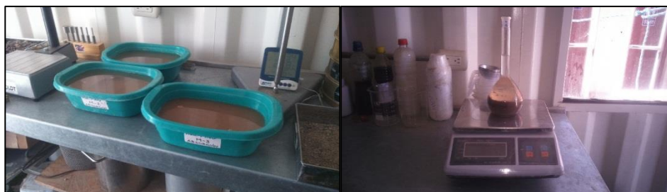
Figura 2-6 Ensayo de Peso Específico del agregado Fino
