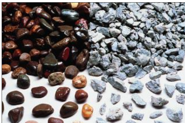
Figura 1-16 Agregado grueso redondeado (izquierda) y agregado grueso chancado (Derecha)
