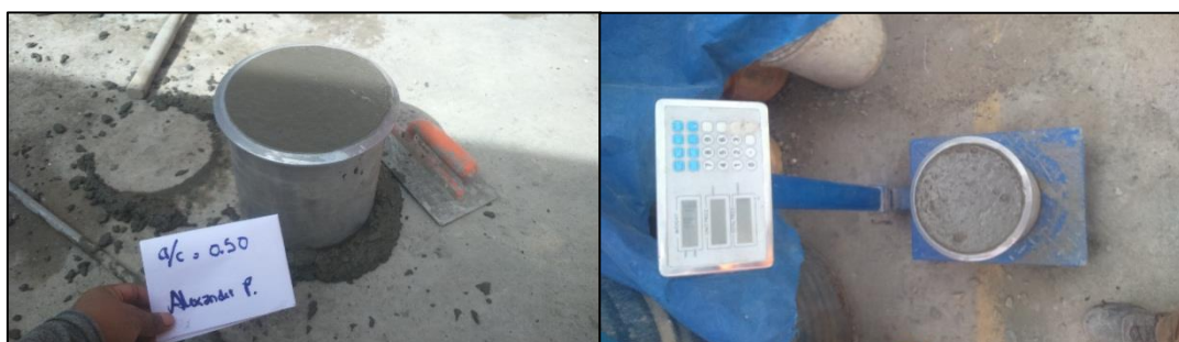
Figura 1-13 Ensayo de Peso Unitario del concreto fresco
