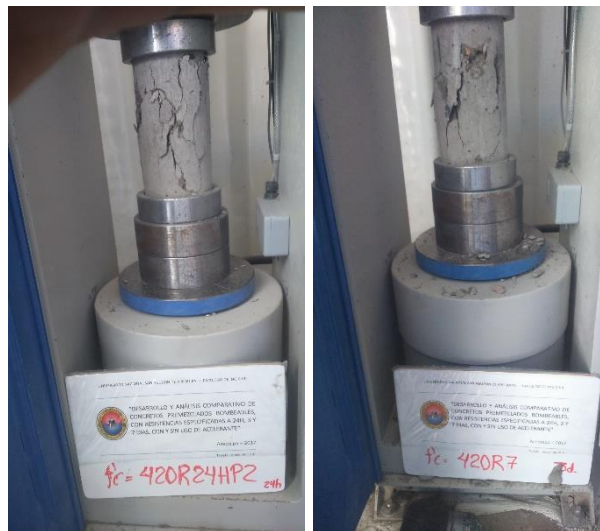
Figura 5-32 Ensayo de Rotura de testigos diseños 420 Kg/cm 2
