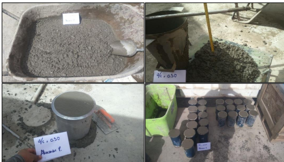
Figura 4-9 caracterización de la mezcla de concreto Diseño D2 ( a/c = 0.50 )
