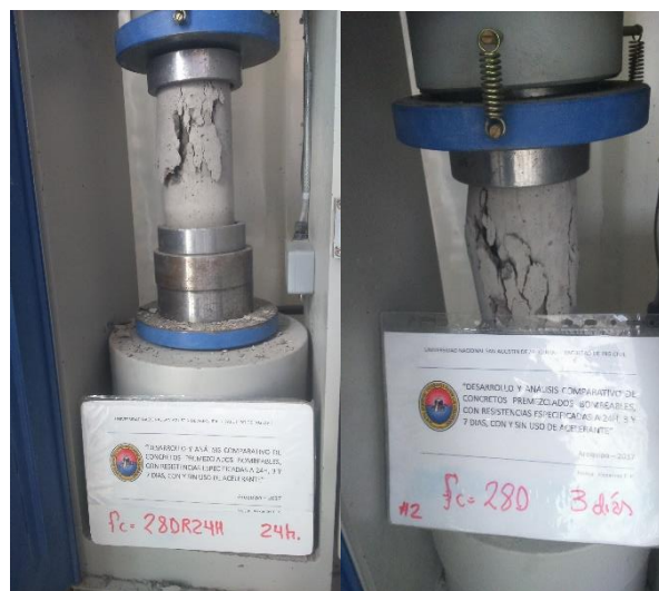
Figura 5-31 Ensayo de Rotura de testigos diseños 280 Kg/cm 2
