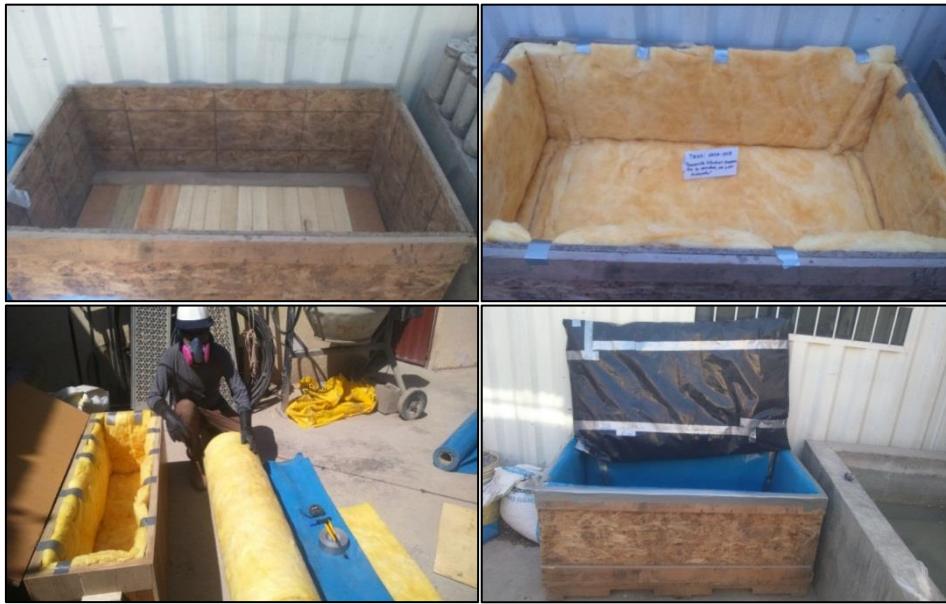
Figura 4-11 Elaboración de caja de madera para el curado inicial de probetas
