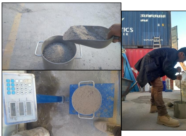
Figura 2-5 Ensayo de Peso Unitario del Agregado Fino
