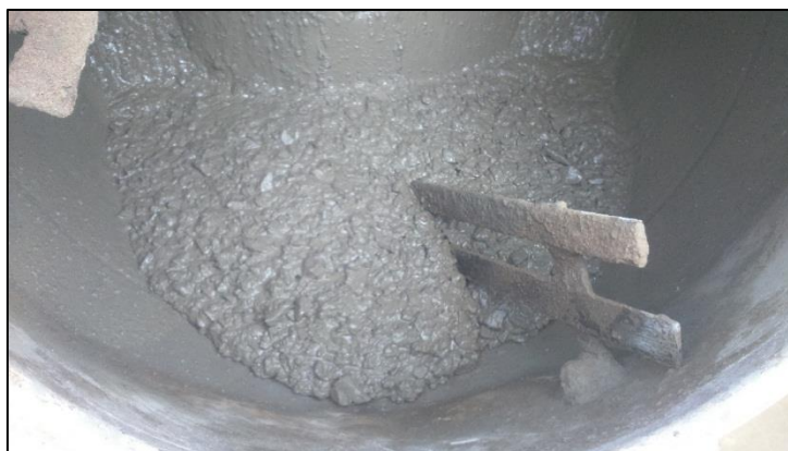
Figura 4-4 Prueba de mezclas en tandas de 15 litros, diseño D2 (% de superplastificante para un slump de 8 a 10”)
