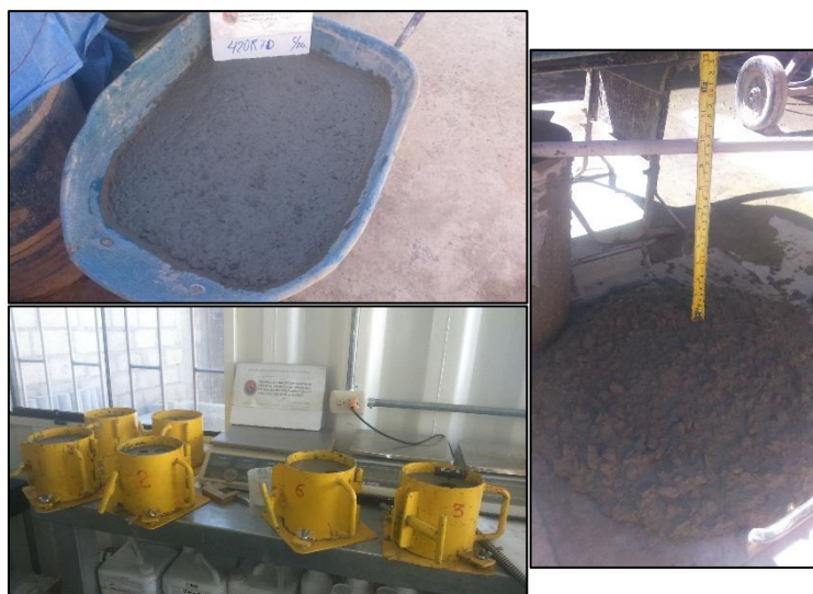
Figura 5-17 Mezcla de concreto con acelerante, revenimiento y ensayos de tiempos de fragua
