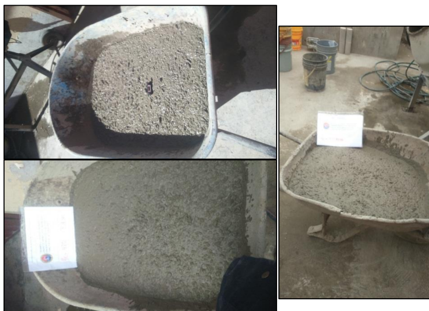
Figura 4-16 Diseños de mezcla 280R7D, 280R3D Y 280R24H (revenimiento entre 8 - 10 pulg.)
