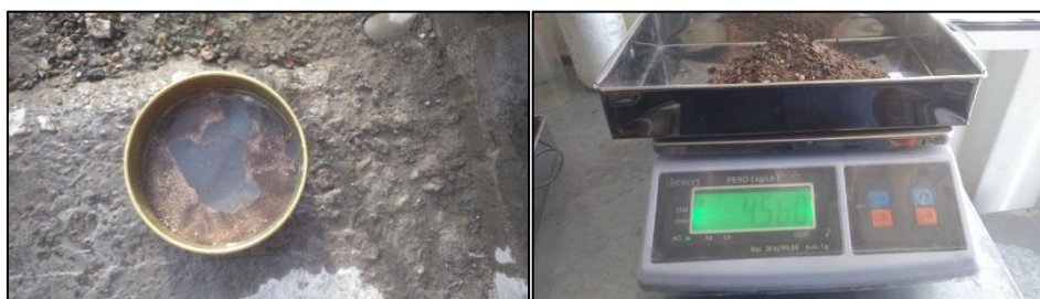
Figura 2-7 Ensayo de Material pasante malla # 200 del Agregado Fino
