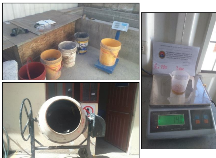
Figura 4-8 Dosificación, pesaje de los insumos de mezcla
