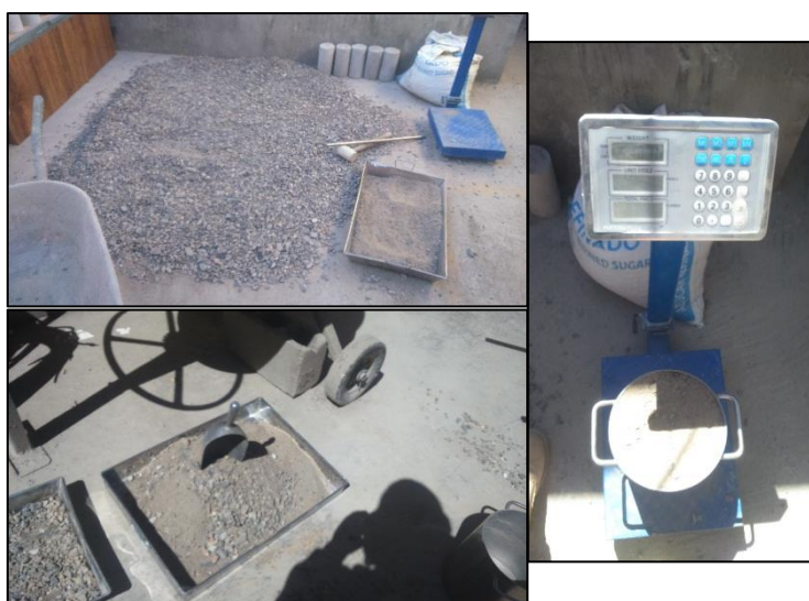
Figura 2-11 Ensayo de máxima compactación de la combinación de agregados
