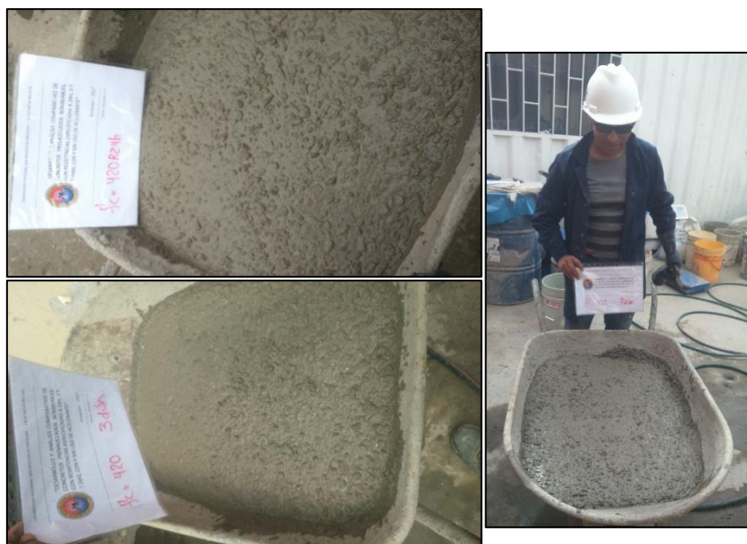
Figura 4-17 Diseños de mezcla 420R7D, 420R3D Y 420R24H (revenimiento entre 8 - 10 pulg.)
