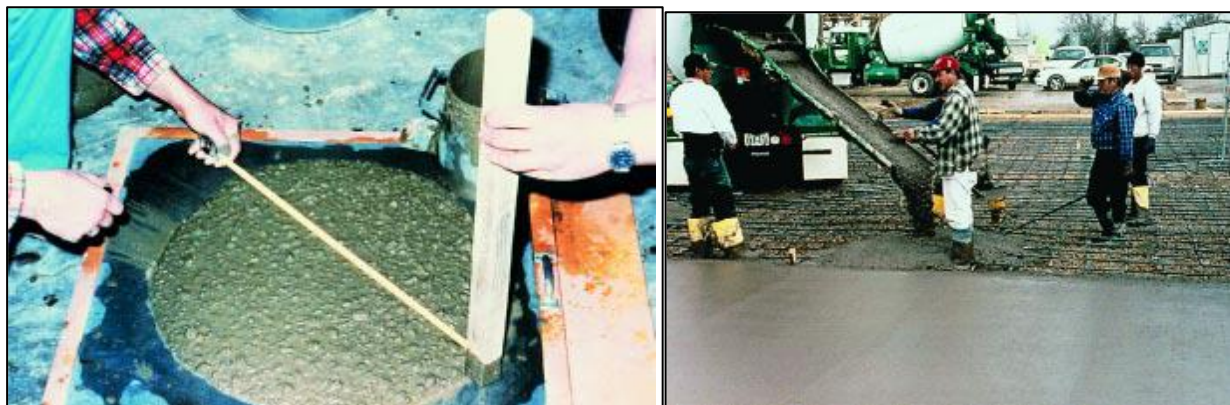
Figura 1-19 Ejemplo de concretos fluidos (slump mayor a 7 ½”)
