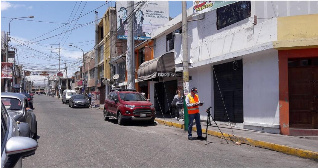
Foto N° 14: Instalación del sonómetro en el Punto 5.
