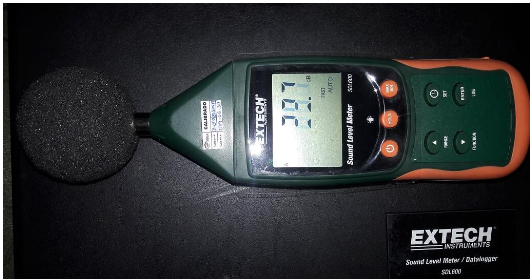
Foto N° 9: Medidor de nivel de sonido (Sonómetro)
