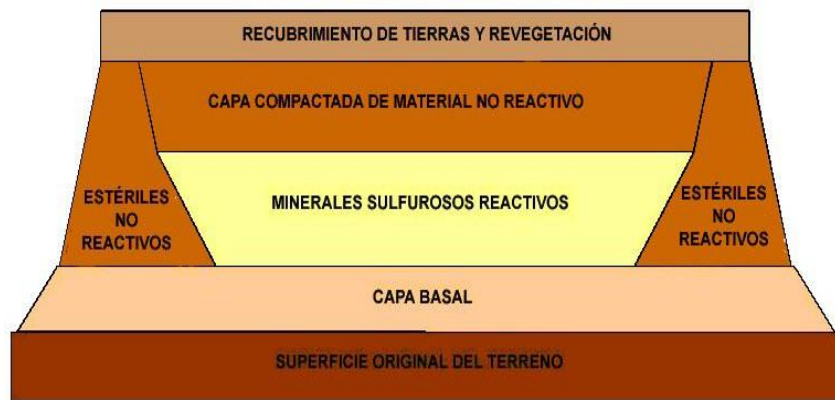
Figura N° 2.5. Colocación selectiva de materiales por encapsulamiento.
