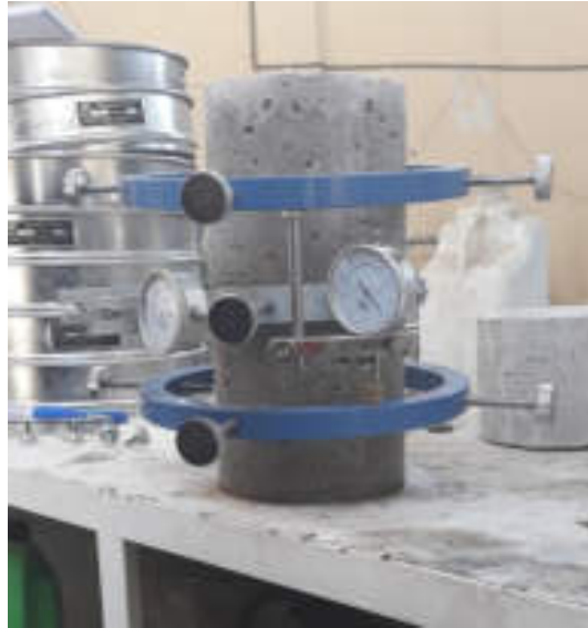
Figura 23: Probeta Armada con los Anillos para Ensayo de Modulo de Elasticidad
