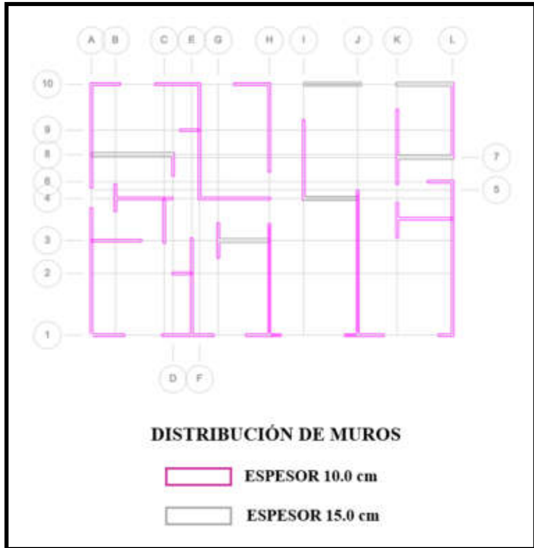
Figura 36: Distribución de muros
