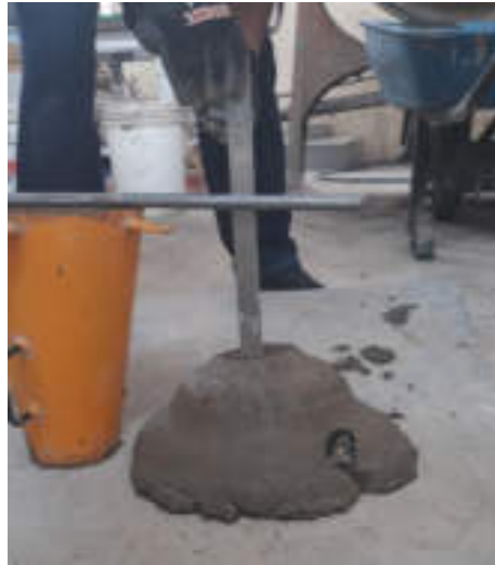
Figura 17: Control de Asentamiento del Concreto
