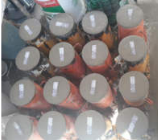
Figura 15: Vaciado de Muestras para los Ensayos
