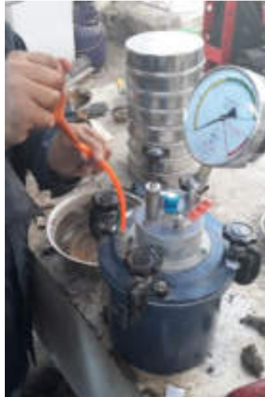
Figura 18: Ensayo de Contenido de Aire del Concreto
