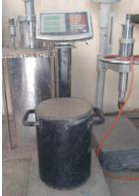
Figura 19: Ensayo de Peso Unitario del Concreto Fresco
