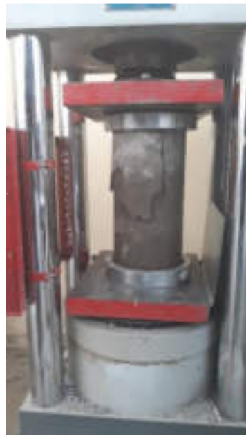
Figura 22: Fin de Ensayo de Resistencia a la Compresión
