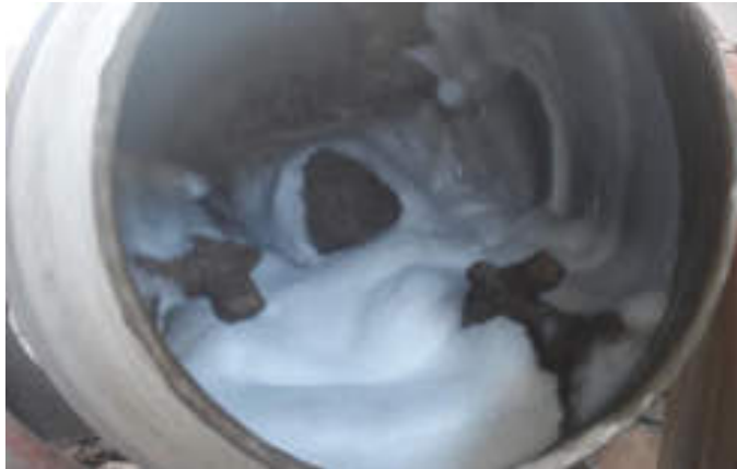
Figura 11: Espuma Generada por el Aditivo Espumante
