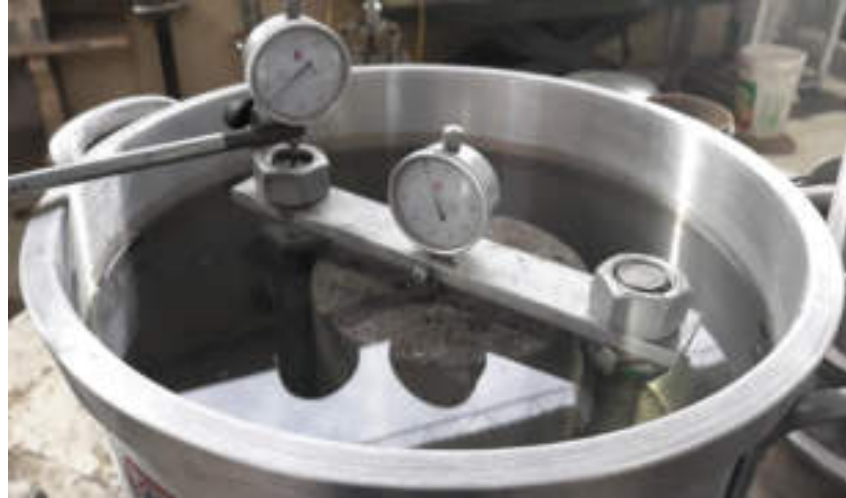
Figura 31: Ensayo para la Obtención del Coeficiente de Expansión Térmico
