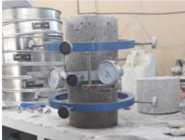
Figura 26: Probeta Armada con los Anillos para Ensayo de Modulo de Elasticidad y Coeficiente de Poisson
