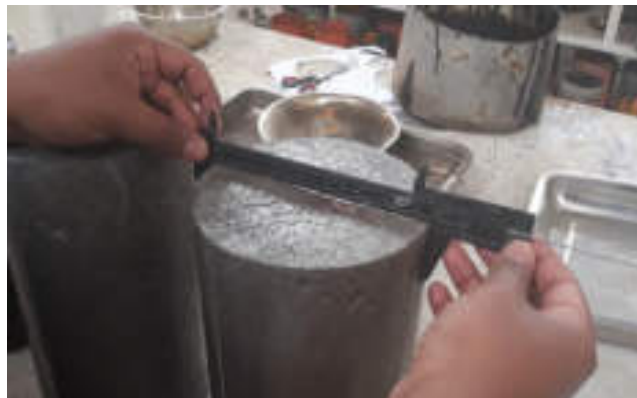
Figura 20: Medición de Diámetro de Probeta
