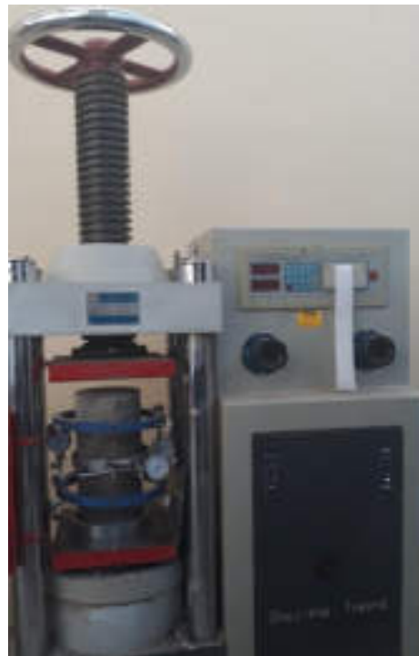
Figura 27: Ensayo de Coeficiente de Poisson
