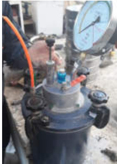
Figura 13: Ensayo de Contenido de Aire
