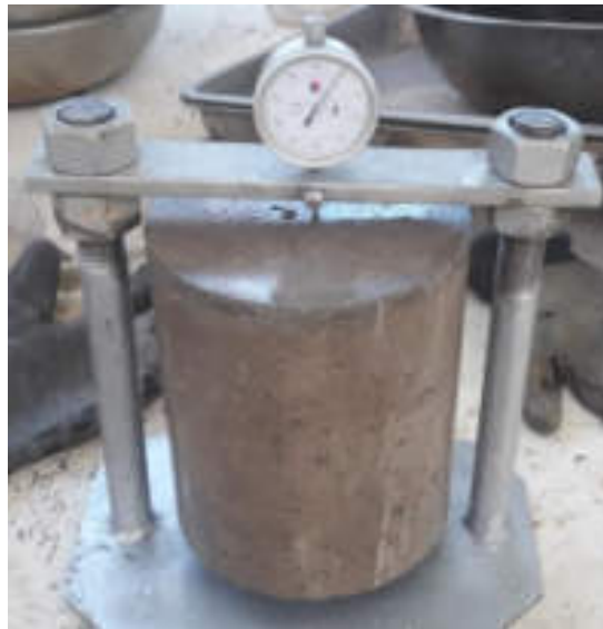
Figura 30: Probeta Armada para el Ensayo de Obtención de Coeficiente de Expansión Térmica
