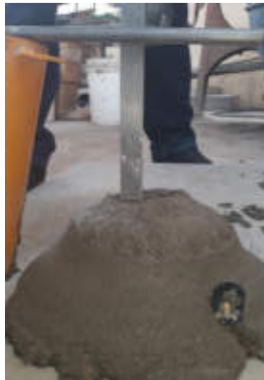
Figura 14: Ensayo de Consistencia
