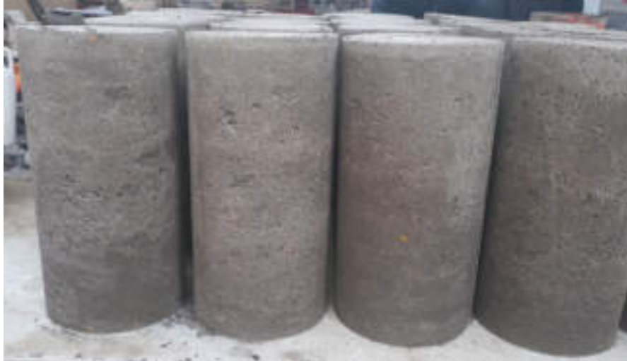
Figura 16: Muestras desmoldadas previa a su introducción en la poza de curado
