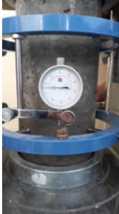
Figura 24: Lectura del Deformímetro durante el ensayo
