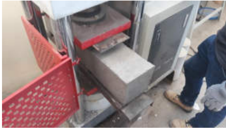
Figura 33: Ensayo de Resistencia a la Flexión Fuente: Elaboración Propia
